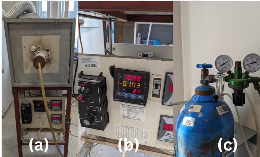
Şekil 3.11. Kullanılmış olan tel rezistanslı fırının; a) önden görünümü; b) kontrol ünitesi ve c) kullanılan argon gaz ünitesi
