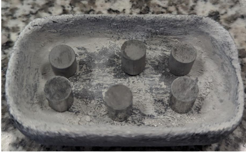
Şekil 3.9. Üretilen 9 mm yükseklikte ve 8 mm çaptaki peletlerin HYS öncesi görüntüleri
