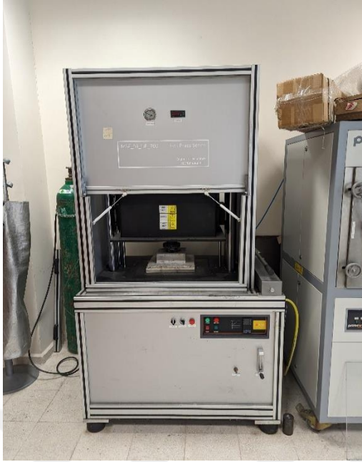
Şekil 3.7. Toz karışımını kalıpta sıkıştırmak için kullanılan presleme cihazı
