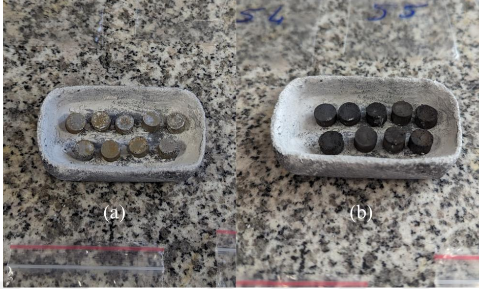
Şekil 3.10. h-BN ile kaplanmış grafit krozeeye konumlandırılan ham parçaların; a) HYS öncesindeki görünümü; b) HYS sonrasındaki görünümü
