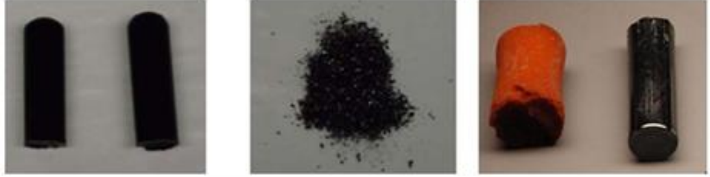
Şekil 1.2. Sol-Jel yöntemi ile sentezlenmiş farklı görünümdeki karbon aerojeller a) silindirik monolit b) öğütülmüş toz şeklinde c) resornisol formaldehit aerogel (solda) ve karbon aerogel (sağ kısım) görüntüleri (Balkabak, 2009)
