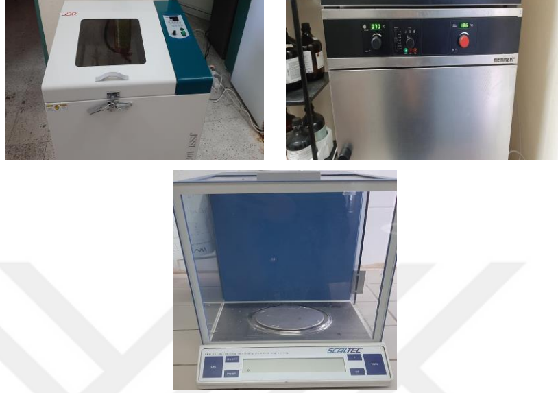
Şekil 3.1. a) Jsr marka yatay karıştırıcı, b) Memmert marka etüv, c) Sacaltec marka hassas terazi
