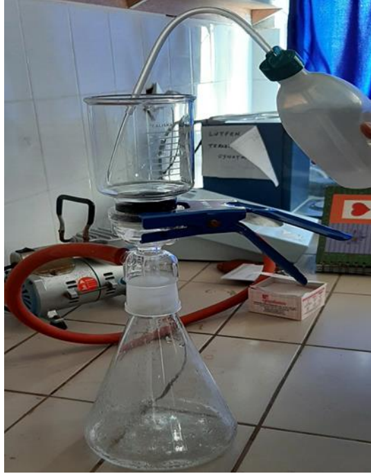
Şekil 3.3. Aerojellerin saf su ile vakum pompası yardımıyla yıkanması
