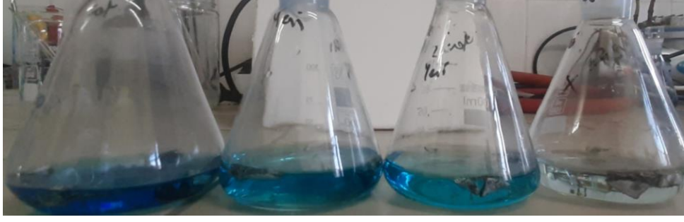
Şekil 3.8. Zamanla %33, %16,5, % 8,25 ve % 4,25 lik metilen mavisi çözeltilerinde görülen renk değişimi
