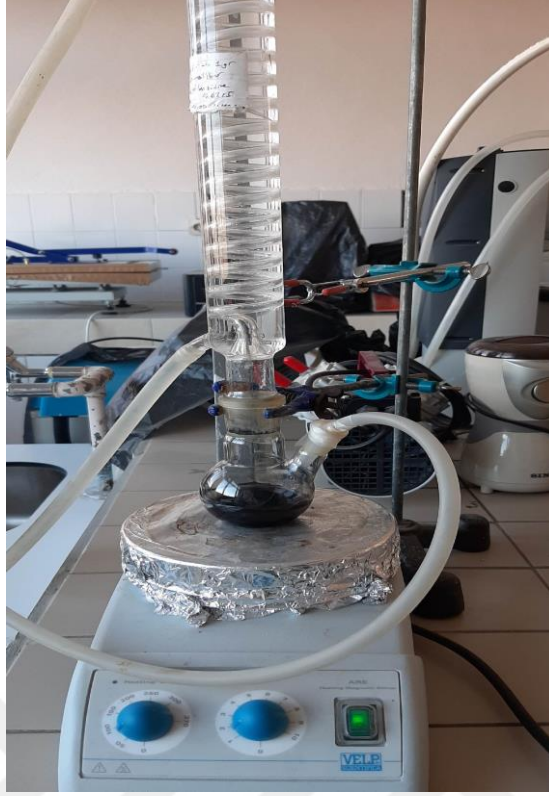
Şekil 3.2. Aerojelin sentezi sırasında geri soğurucu sisteme bağlanması ve sisteme N_2 gazı verilmesi
