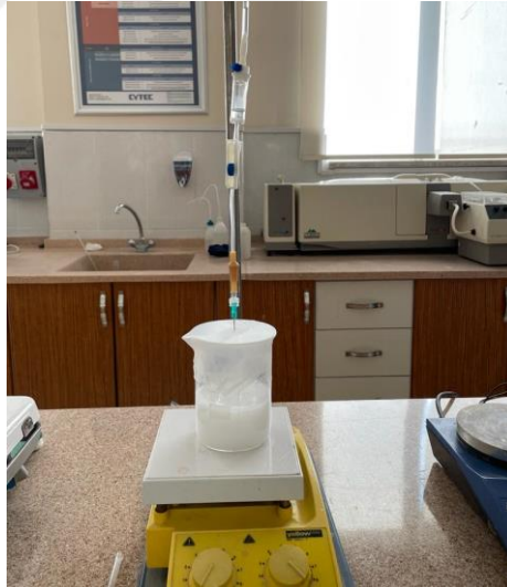
Resim 3.1 CTAB/TEOS çözeltisinin PCC dispersiyona eklenmesi.
