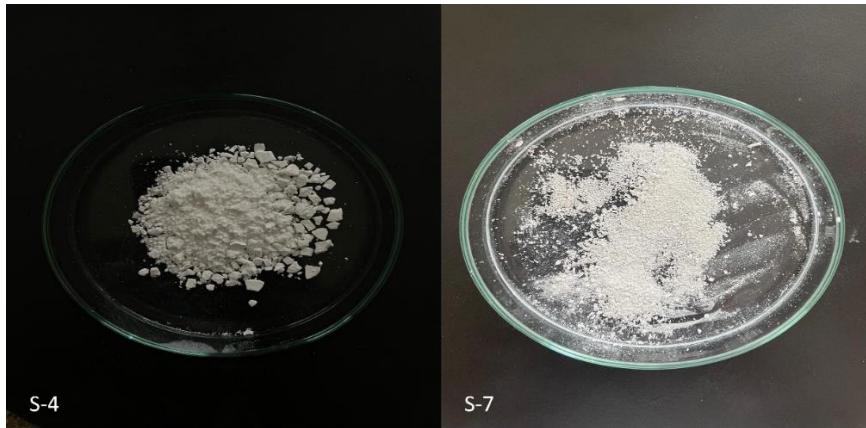
Resim 3.3 Sentezlenen gözenekli ve küresel nano kabuklar.
