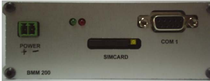
Resim 5.2. Paket anahtarlama radyo hizmetleri modemi RS232 bağlantısı
