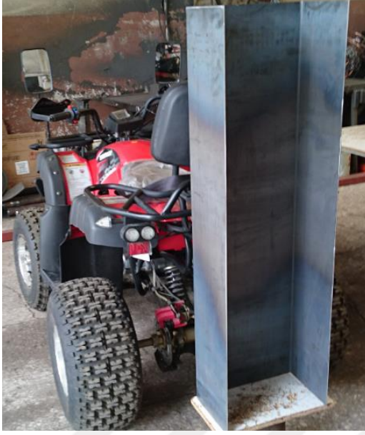
Şekil 3.5 Makina gövdesinin arazi taşıtı üzerinde montajı
