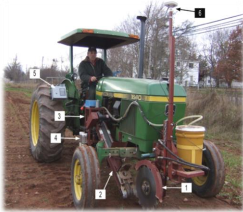
Şekil 2.7. GPS Destekli toprak nitrat azotu haritalama makinası 1) Toprak örnekliyişi 2) Toprak elevatörü, 3) Nitrat Ölçümü 4) Otomatik Kalibrasyon 5) Kontrol Ünitesi 6) Küresel Konumlama Sistemi (GPS)
