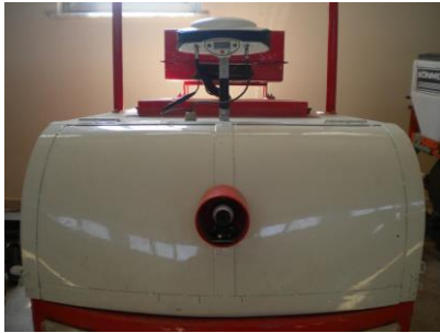
Şekil 2.19. GPS alıcısının mobil robot üzerindeki yerleşimi
