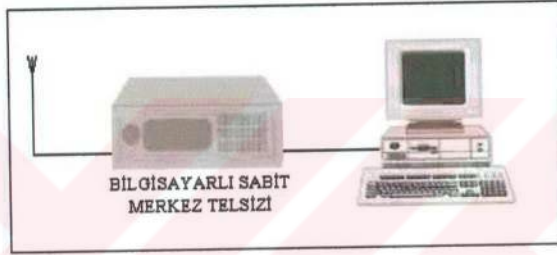
Şekil 5.4. Taksi GPS Sistemi Merkez Konfigürasyonu
