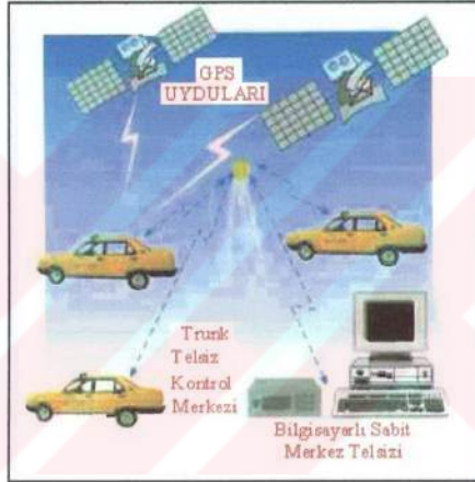
Şekil 5.2 Taksi GPS sisteminin genel yapısı.
