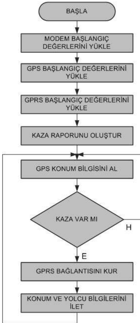
Şekil 4.2. Araç ünitesi istemci yazılımı akış diyagramı
