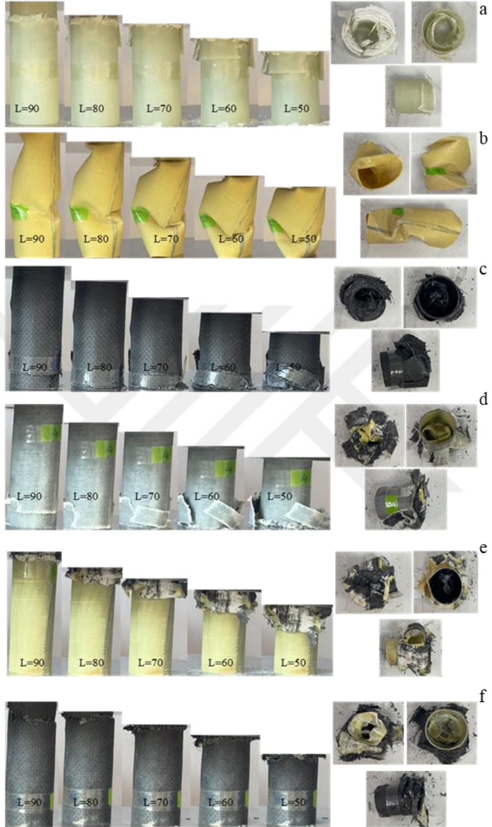
Şekil 4.27. S37 – S42 numunelerinin deney sırasında boy değişimi nihai ezilmiş son şekilleri: a) GFRP H1000 b) AFRP H1000 c) CFRP H1000 d) ACGFRP H1000 e) CGAFRP H1000 f) GACFRP H1000
