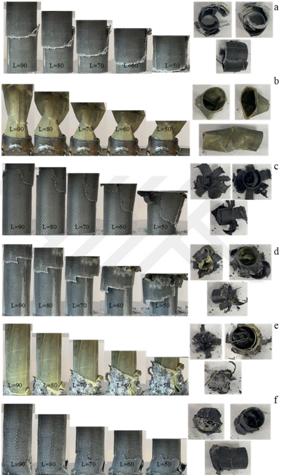
Şekil 4.19. S25 – S30 numunelerinin deney sırasında boy değişimi ve nihai ezilmiş son şekilleri: a) GFRP %0,25GNP H500 b) AFRP %0,25GNP H500 c) CFRP %0,25GNP H500 d) ACGFRP %0,25GNP H500 e) CGAFRP %0,25GNP H500 e) GACFRP %0,25GNP H500
