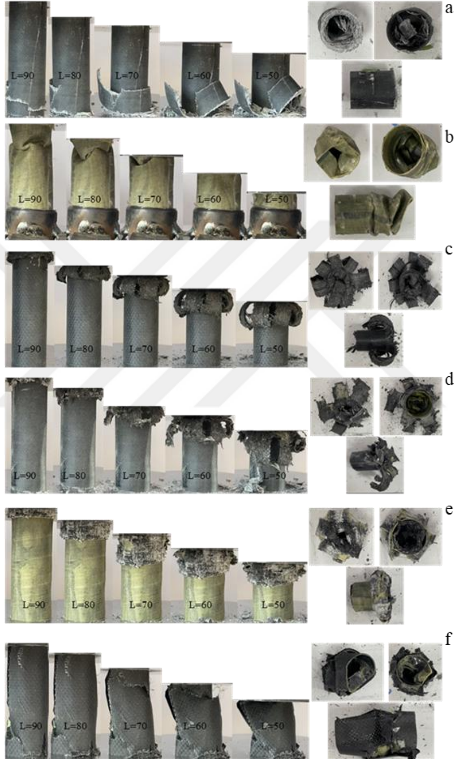
Şekil 4.31. S43 – S48 numunelerinin deney sırasında boy değişimleri nihai ezilmiş son şekilleri: a) GFRP %0,25GNP H1000 b) AFRP %0,25GNP H1000 c) CFRP %0,25GNP H1000 d) ACGFRP %0,25GNP H1000 e) CGAFRP %0,25GNP H1000 e) GACFRP %0,25GNP H1000
