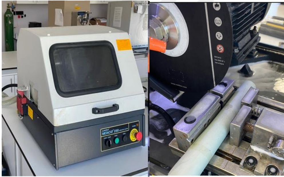
Şekil 3.10. a) Kesme işlemlerinin yapıldığı Metkon Metacut 250 cihazı b) Numunenin kesme işlemi
