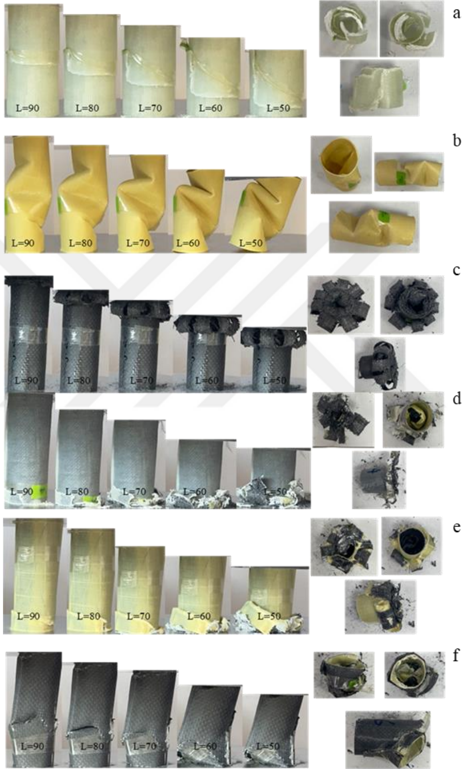
Şekil 4.15. S19 – 24 numunelerinin deney sırasında boy değişimleri ve nihai ezilmiş son şekilleri: a) GFRP H500 b) AFRP H500 c) CFRP H500 d) ACGFRP H500 e) CGAFRP H500 f) GACFRP H500
