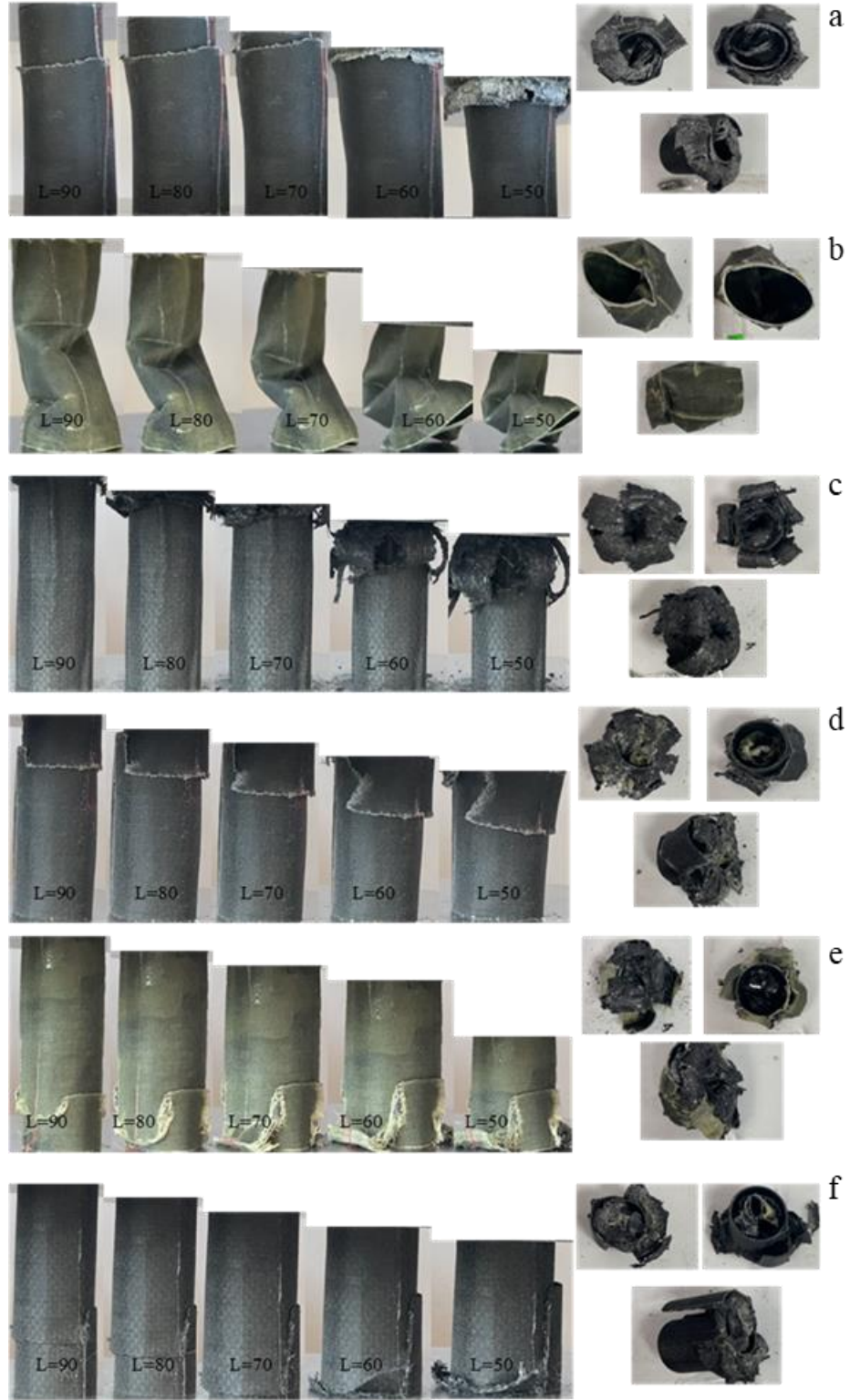
Şekil 4.11. S13 – 18 numunelerinin deney sırasında boy değişimleri ve nihai ezilmiş son şekilleri: a) GFRP %0,50GNP b) AFRP %0,50GNP c) CFRP %0,50GNP d) ACGFRP %0,50GNP e) CGAFRP %0,50GNP e) GACFRP %0,50GNP
