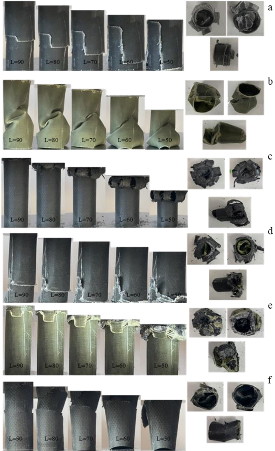
Şekil 4.7. S7 – 12 numunelerinin deney sırasındaki boy değişimleri ve nihai ezilmiş son şekilleri: a) GFRP %0,25GNP b) AFRP %0,25GNP c) CFRP %0,25GNP d) ACGFRP %0,25GNP e) CGAFRP %0,25GNP f) GACFRP %0,25GNP
