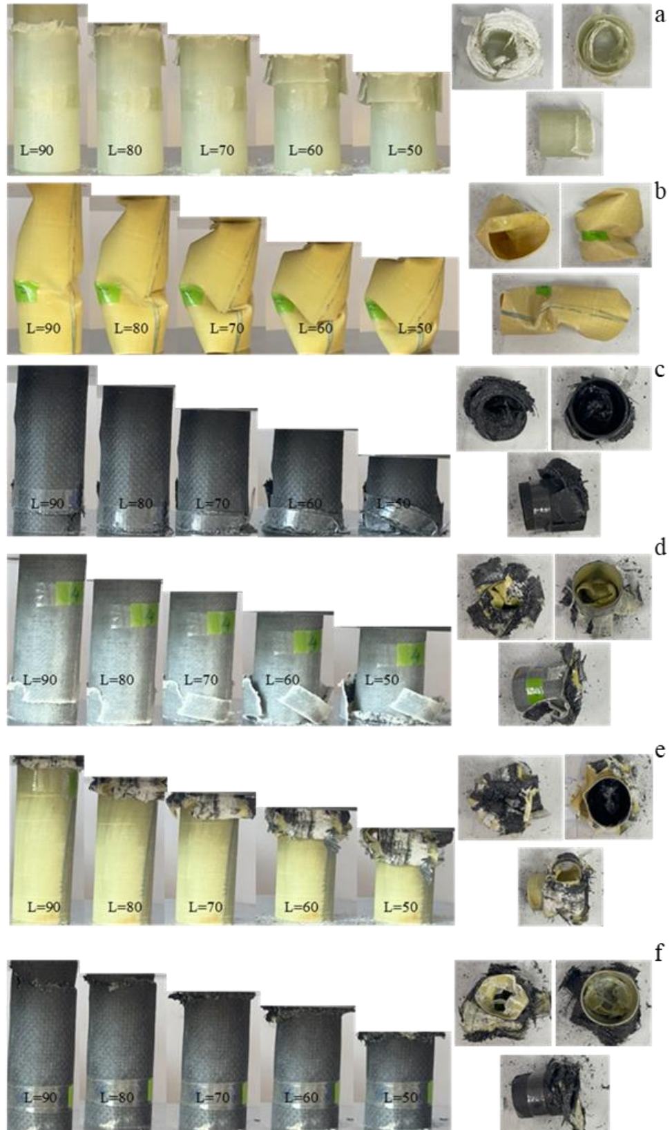
Şekil 4.27. S37 – S42 numunelerinin deney sırasında boy değişimi nihai ezilmiş son şekilleri: a) GFRP H1000 b) AFRP H1000 c) CFRP H1000 d) ACGFRP H1000 e) CGAFRP H1000 e) GACFRP H1000
