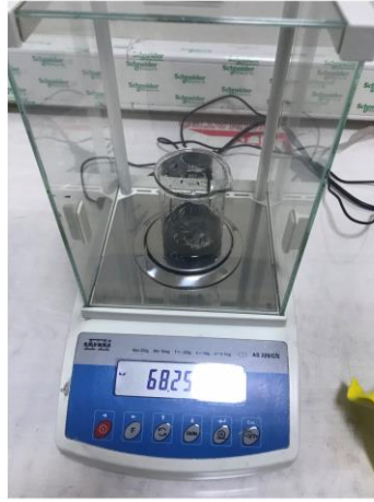
Grafen ve epoksi yapıştırıcının tartılması
