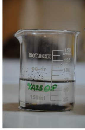
Aseton – grafen nano partikül karışımı
