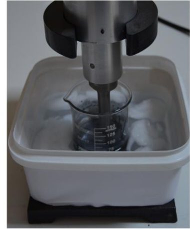
Grafen – epoksi karışımının buz banyosunda ultrasonik karıştırıcı ile karıştırılması
