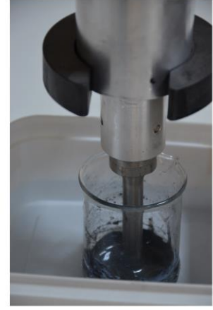
Grafen nano partikülün aseton içerisinde ultrasonik karıştırıcı ile çözülmesi
