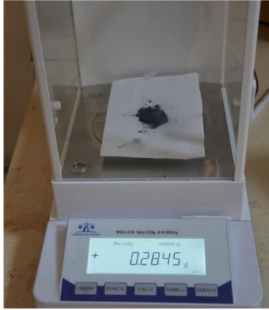
Grafen nano partiküllerin tartılması
