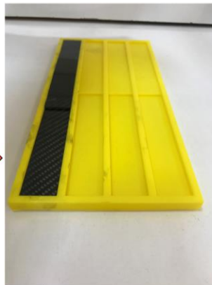
Tek bindirmeli bağlantıların hazırlanan kalıpta birleştirilmesi
