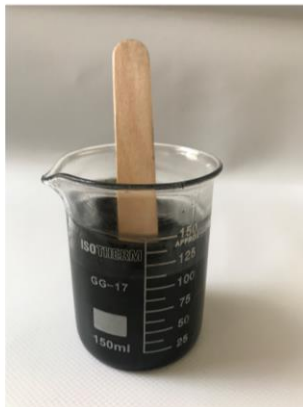
Yapıştırıcı – grafen karışımına hızlandırıcının eklenmesi ve elle karıştırma
