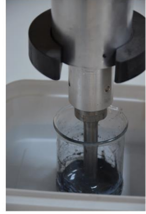
Grafen nano partikülün aseton içerisinde ultrasonik karıştırıcı ile çözülmesi
