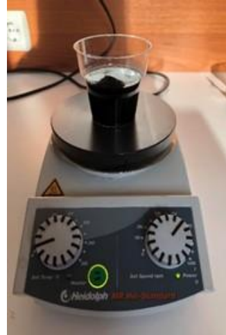
Şekil 3.4. Tartılan malzemelerin manyetik karıştırıcıda karıştırılması
