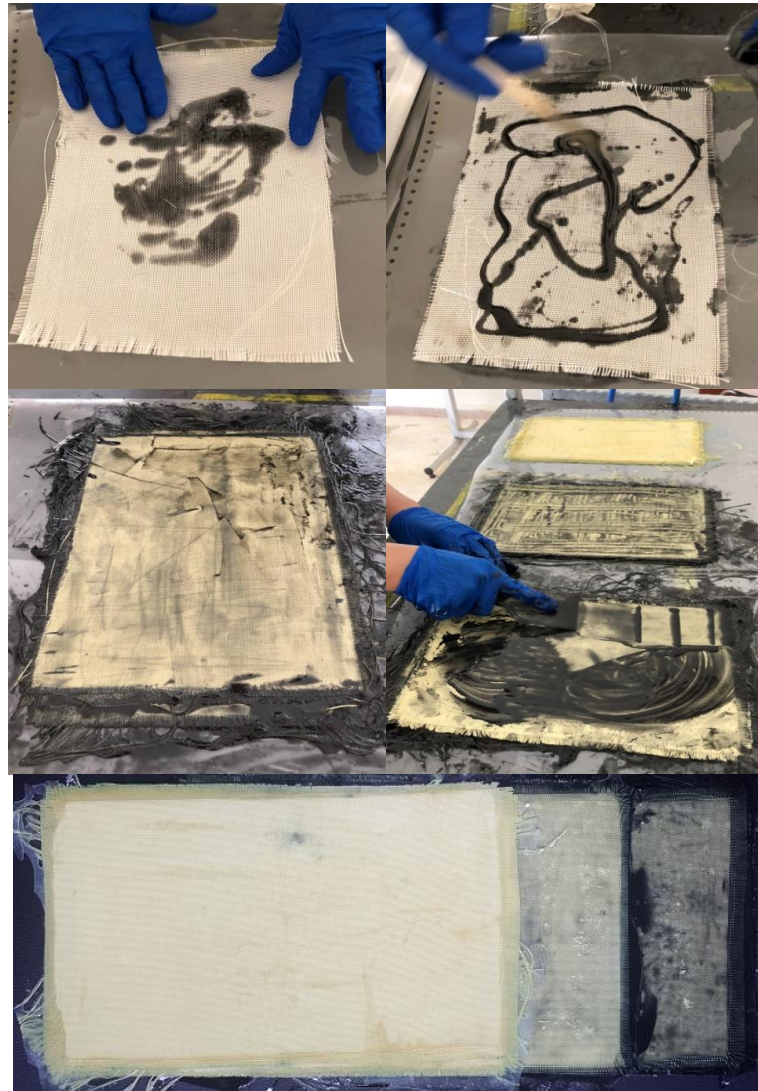
Şekil 3.11. Elle yatırma yöntemiyle üretilen kompozitler
