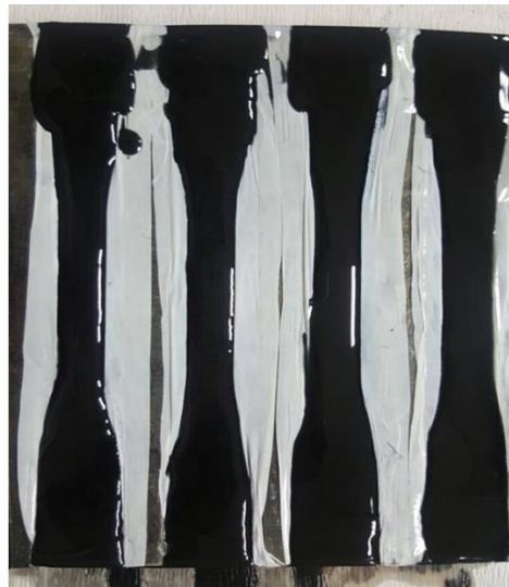
Şekil 3.5. Karışımların kalıba dökülmesi
