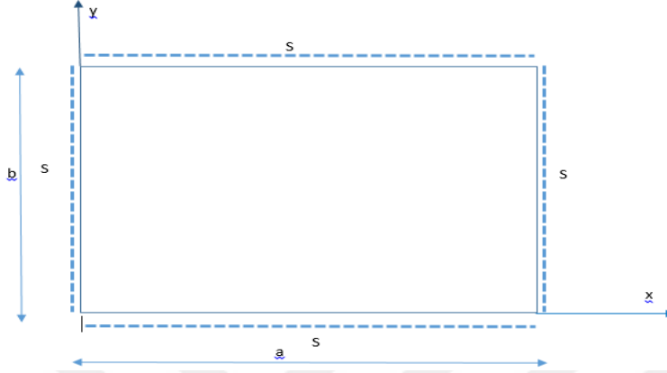
Şekil 4.6. Dört kenarı basit mesnetli dikdörtgen plak
