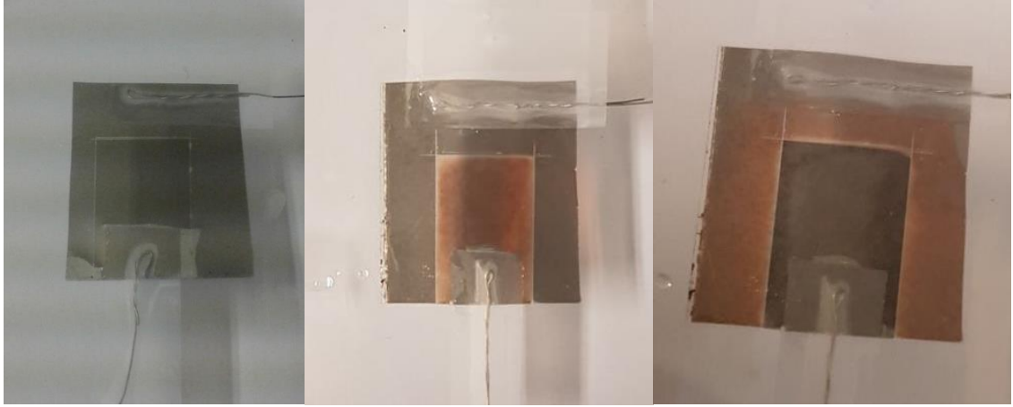
Şekil 4.12. Düzlemsel yapıya sahip çok katmanlı grafen elektrotlarda artı elektrot olarak kullanılan bölgenin değişmesi sonucu 5V altında elektrokromik aygıtın görüntüsü
