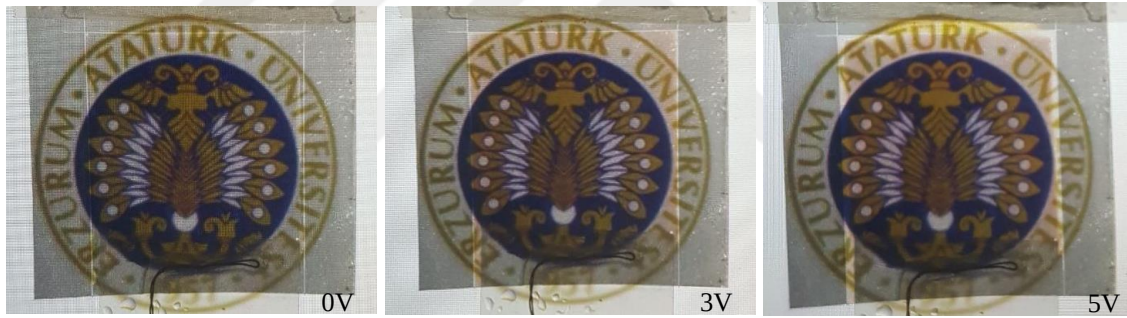
Şekil 5.6. 5x5 cm 2 alana sahip co-planer aygıt yapısına sahip çok katmanlı grafen elektrot tabanlı elektrokromik aygıtın 0V/3V/3,5V uygulama potansiyeli altında fotoğrafı
