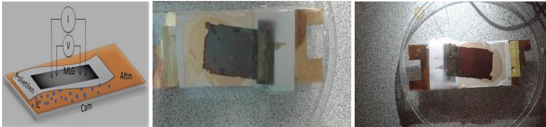
Şekil 4.14. Dört nokta prob ölçümleri için kullanılan elektrokromik aygıt dizaynı ve aygıtın 0V ve +3,5V uygulama voltajı altında fotoğrafı
