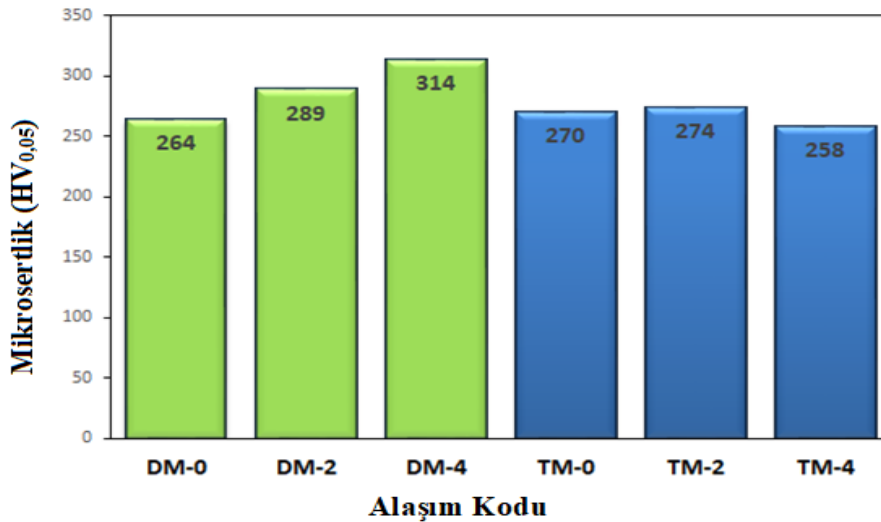
Şekil 4.5 Alaşımların mikrosertlik grafiği.
