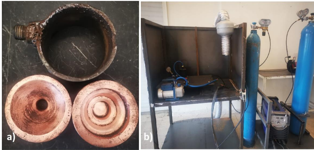
Şekil 3.3 Ergitme döküm işleminde a) Bakır kalıp b) Üretim sistemi resmi
