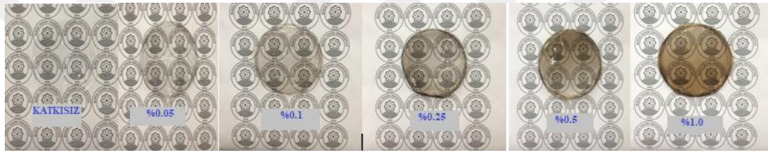
Şekil 2.2: GO/PVA Nanokompozit Filmlerin Görüntüleri.
