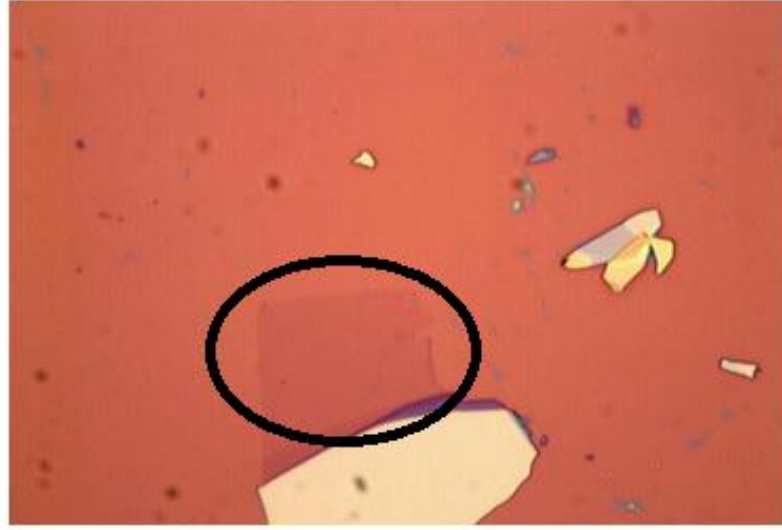
Şekil 4.2 Optik mikroskobun 100X merceği altında HOPG den elde edilen grafenin görüntüsü.
