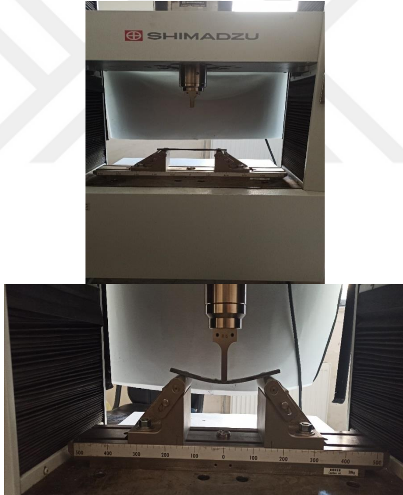
Şekil 5.7. Eğilme testi cihazı ve eğilme sonrası oluşan şekil
