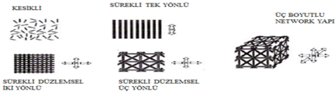
Şekil 3.4. Kompozit malzeme içerisindeki elyafların dağılımı (Saçak, 2002)
