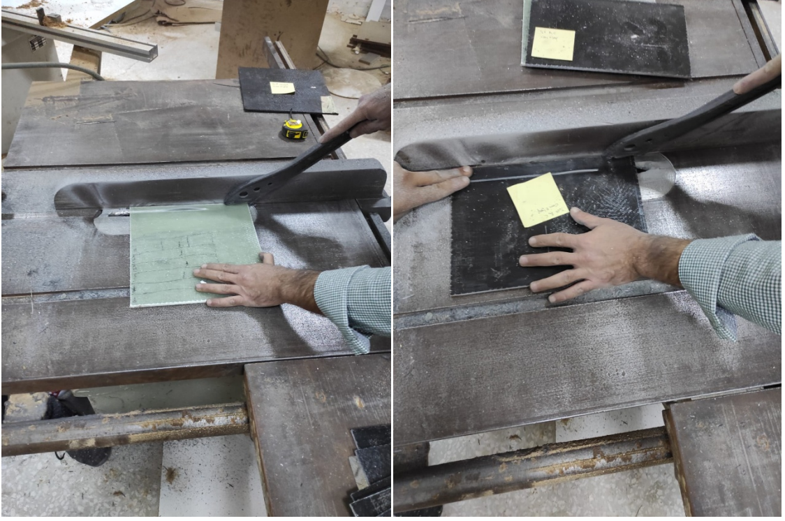
Şekil 5.4. Kompozit plakaların kesimi ile deney numunelerinin elde edilişi
