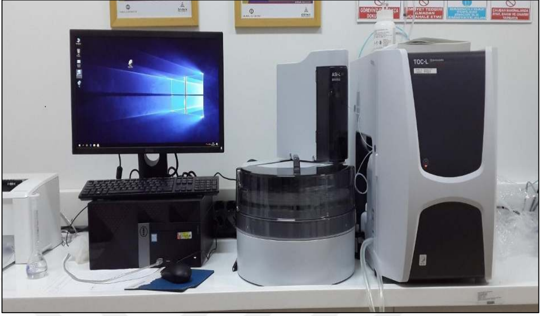
Görsel. 5.4. Toplam organik karbon tayini için kullanılan TOC cihazı (TOC-L Shimadzu)
