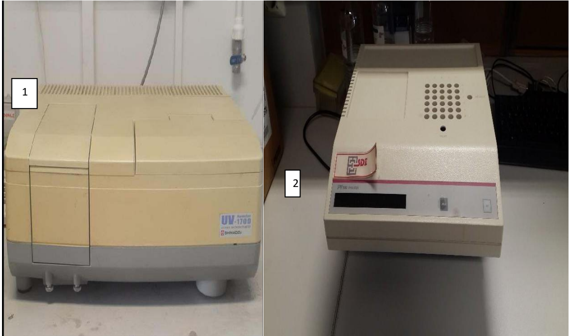
Görsel 5.3. Renk parametresini belirlemek için kullanılan 1. UV- Spektrofotometre (UV-1700 Pharma Spectro Shimadzu) ve toksisite deneyleri için kullanılan 2. Mikrotoksosite (Azur Enviromental/Microtox)
