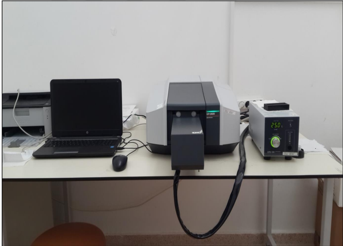
Görsel 5.5. UV-Spektrum almak için kullanılan UV-VIS Spektrofotometre (UV-2600 UV-VIS Spektrofotometre Shimadzu)
