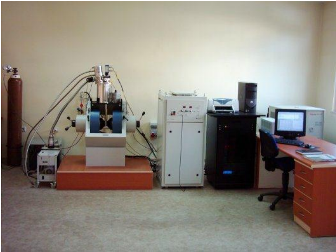
Resim 3.6. Lake Shore 7700 serisi Hall etkisi ölçüm sistemi.
