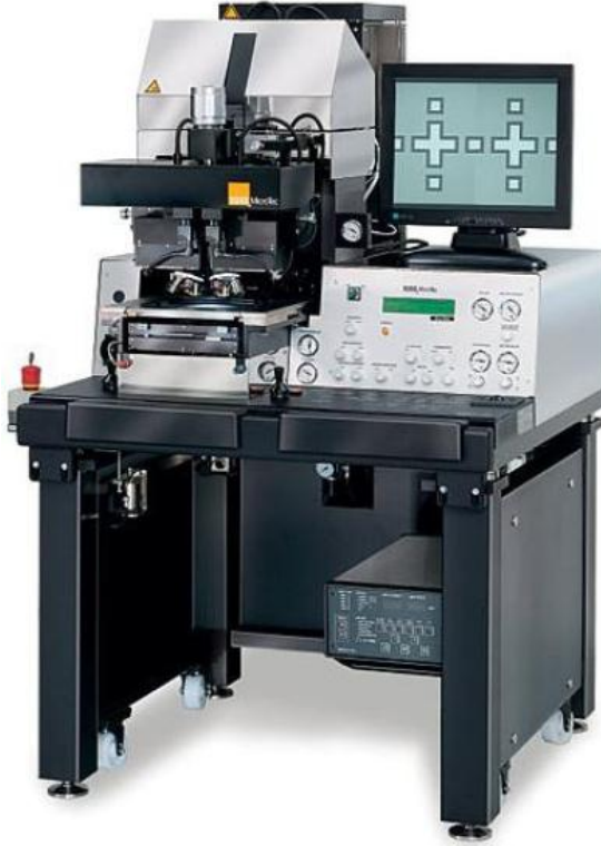
Resim 3.2. Karl Suss MA6 model optik litografi sistemi.
