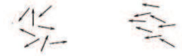
Şekil 2.8. Uygulanan elektrik alan etkisinde, iyonların etkisinde kalıcı dipollerin yönü (oklar) ve yönsel polarizasyon oluşumu
