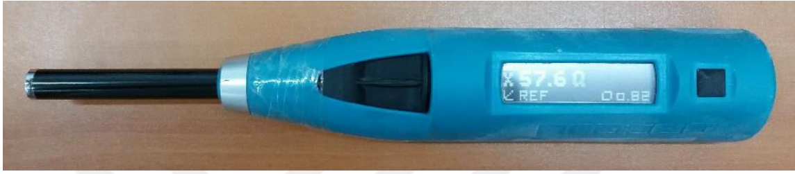
Şekil 6. Dijital schmidt çekici tip L
