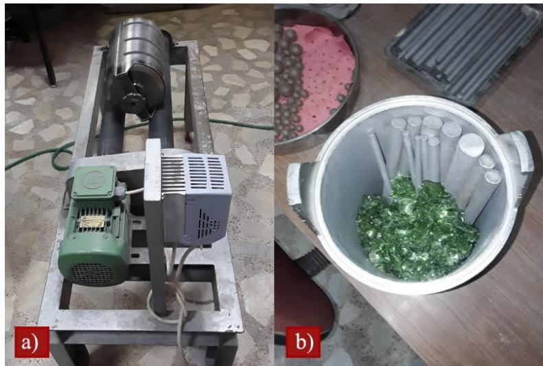
Şekil 17. a) Öğütme makinesi ve b) değirmen çubukları
