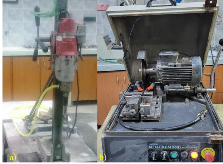
Şekil 9. a) Karot alma makinesi ve b) karot kesme testeresi
