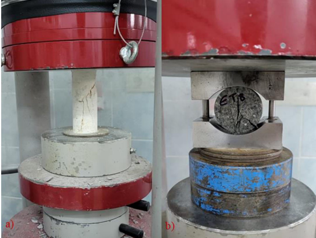
Şekil 10. a) Tek Eksenli Basma Dayanımı ve b) Endirekt Çekme Dayanımı deneylerinin uygulanması
