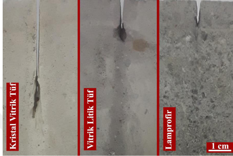
Şekil 55. Beton aşındırıcısı ile kesilen iş parçalarının kerf profilleri
