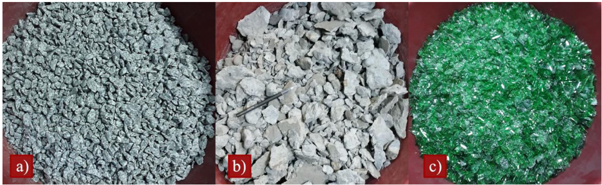
Şekil 15. a) Granit kırıntıları, b) beton atığı ve c) cam atığı (Ferrokrom cürufu toz olarak temin edilmiştir. Sadece elemeye tabi tutulmuştur.)
