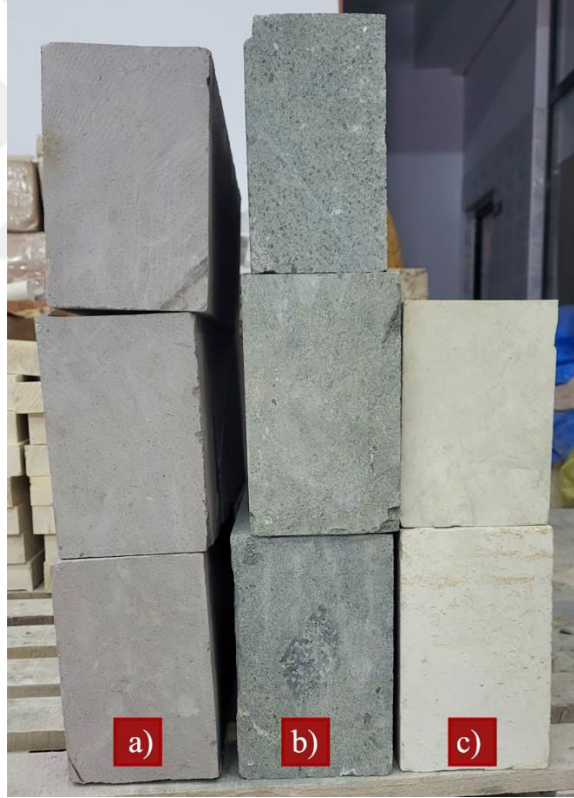
Şekil 5. Kullanılan doğal taşlar: a) Vitrik Litik Tüf, b) Lamprofir ve c) Kristal Vitrik Tüf
