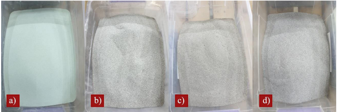
Şekil 19. Kesime hazır olan aşındırıcılar: a) Cam, b) Granit, c) Beton ve d) Ferrokrom Cürufu
