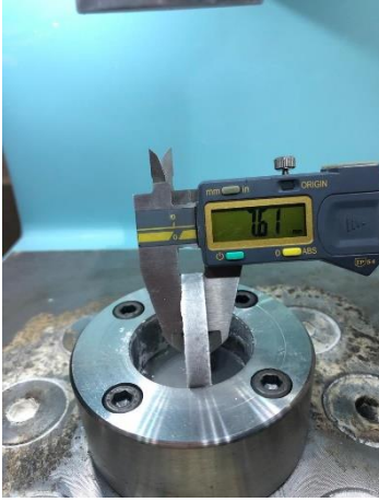
Şekil 3.17: a) Pişme Öncesi Kumpas Ölçümü b) Pişme Sonrası Kumpas Ölçümü.
