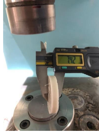
Şekil 3.17: a) Pişme Öncesi Kumpas Ölçümü b) Pişme Sonrası Kumpas Ölçümü.
