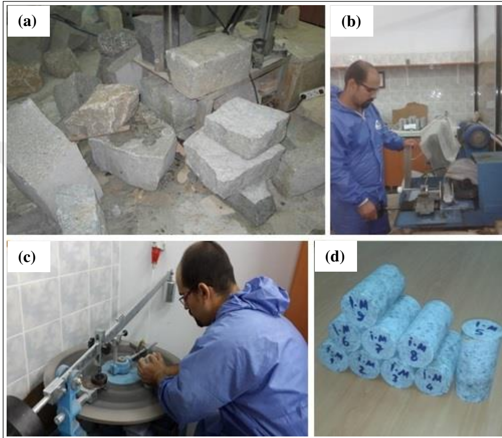
Şekil 2.2. Numunelerden karotların alınması (a), kesilerek boyutlandırılması (b), alt-üst yüzeylerinin düzleştirilmesi (c) ve hazırlanmış numunelerin görünümü (d)
