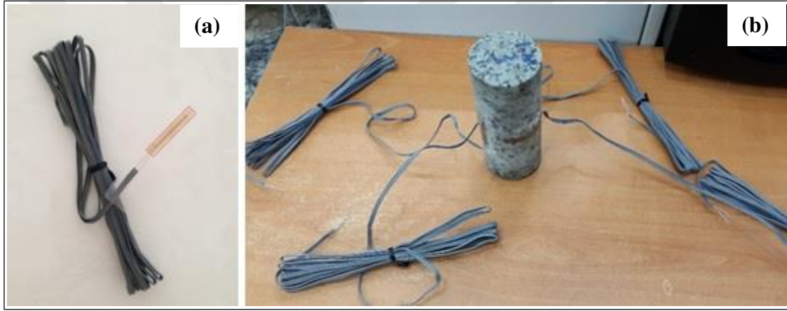
Şekil 2.4. TML deformasyon ölçer (a) ve deformasyon ölçer yapıştırılmış numunenin görünümü (b)
