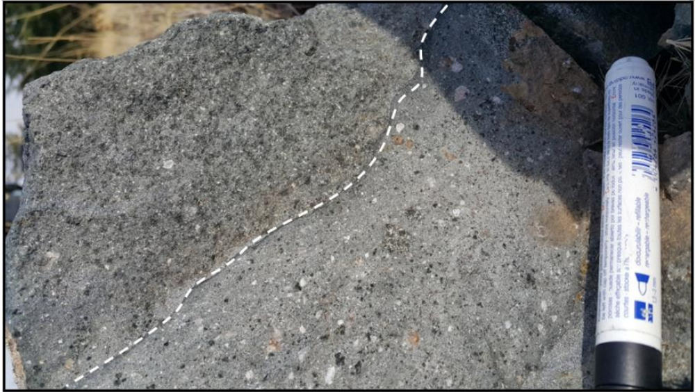
Şekil 2.44: Sırayalar gabrosunun porfirik ve ince taneli dokusunun dokanak ilişkisi.
