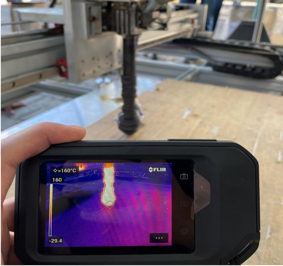
Görsel 3.24. Termal kamera ile sıcaklık kontrolleri
