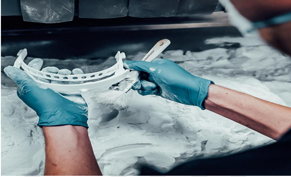
Görsel 1.6. Covid-19'e karşı Daimler'e ait maskenin Sls imalatı (Daimler, 2020)
