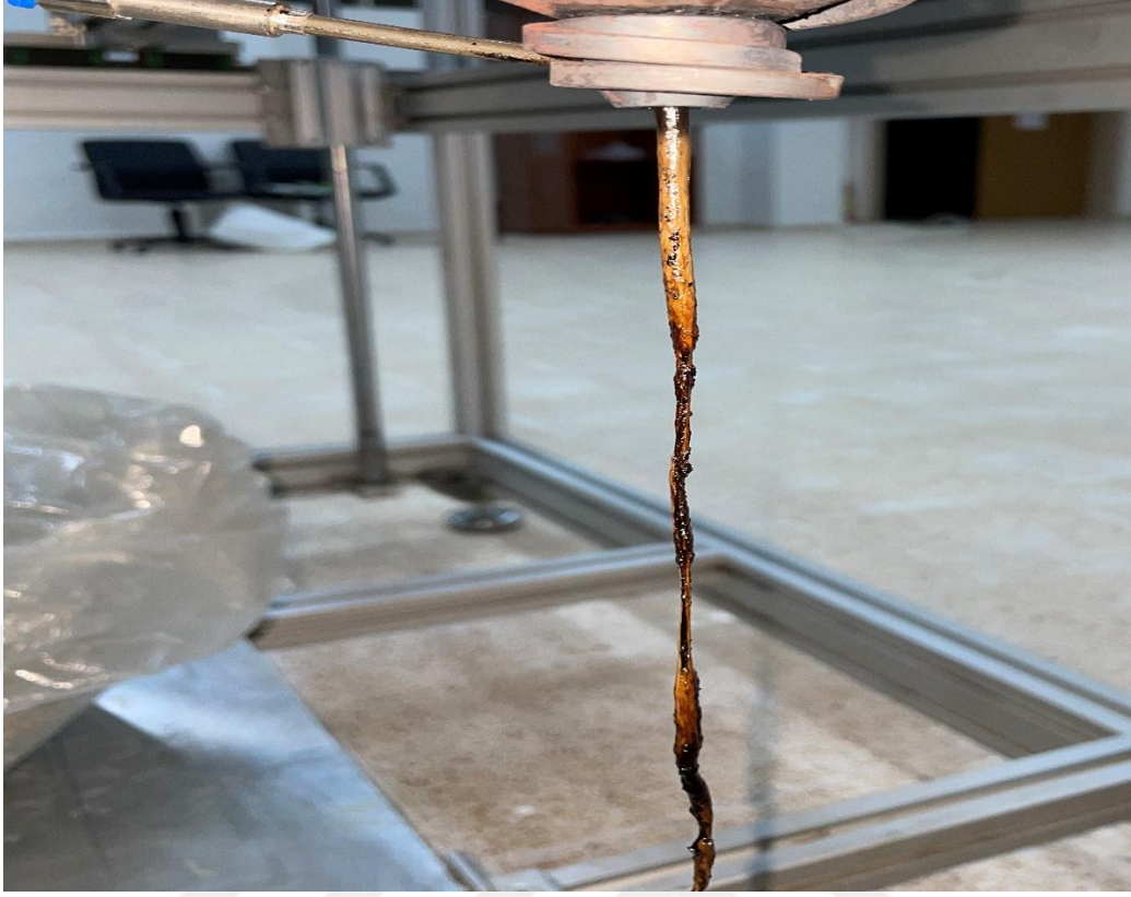
Görsel 3.32. Peek malzemenin ekstruder akış sorunu
