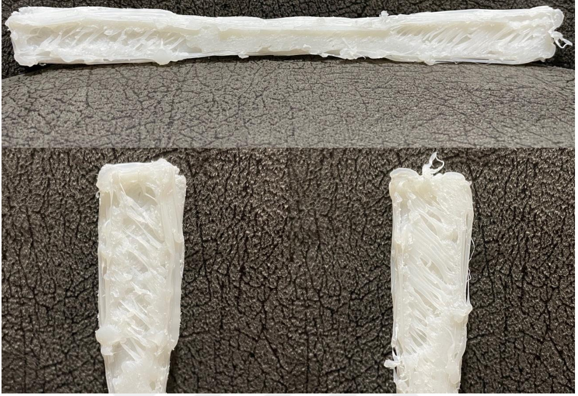
Görsel 3.35. Seviye 1'deki deney 3 için eksik malzeme akış hatalı ASTM D638 çekme test numunesi
