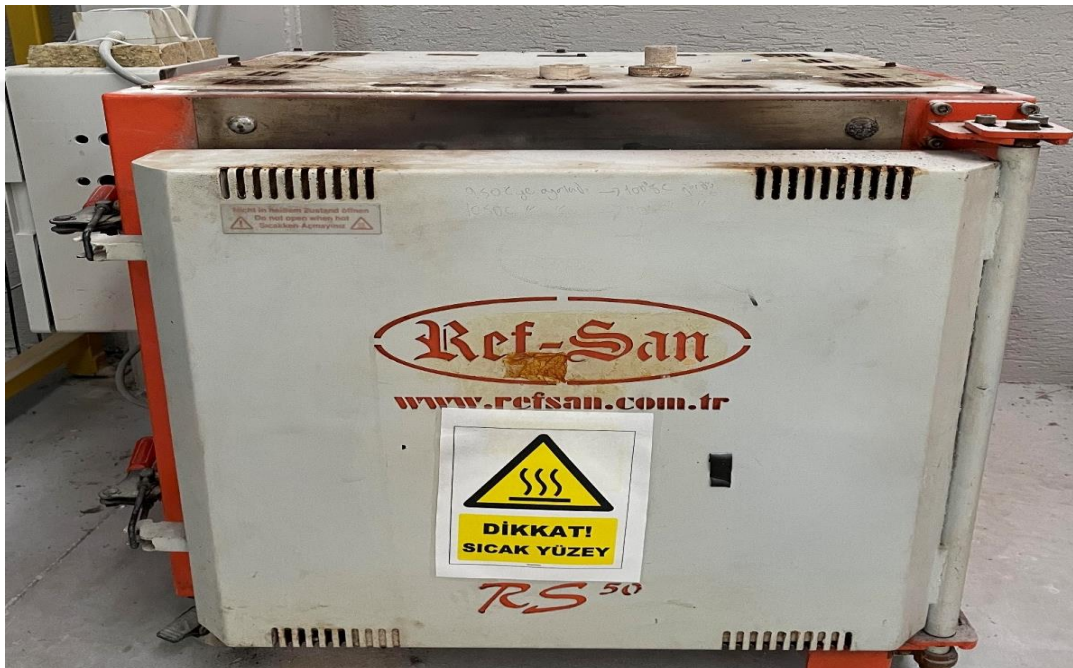
Görsel 3.30. Kamara tip ısıtıl işlem fırını
