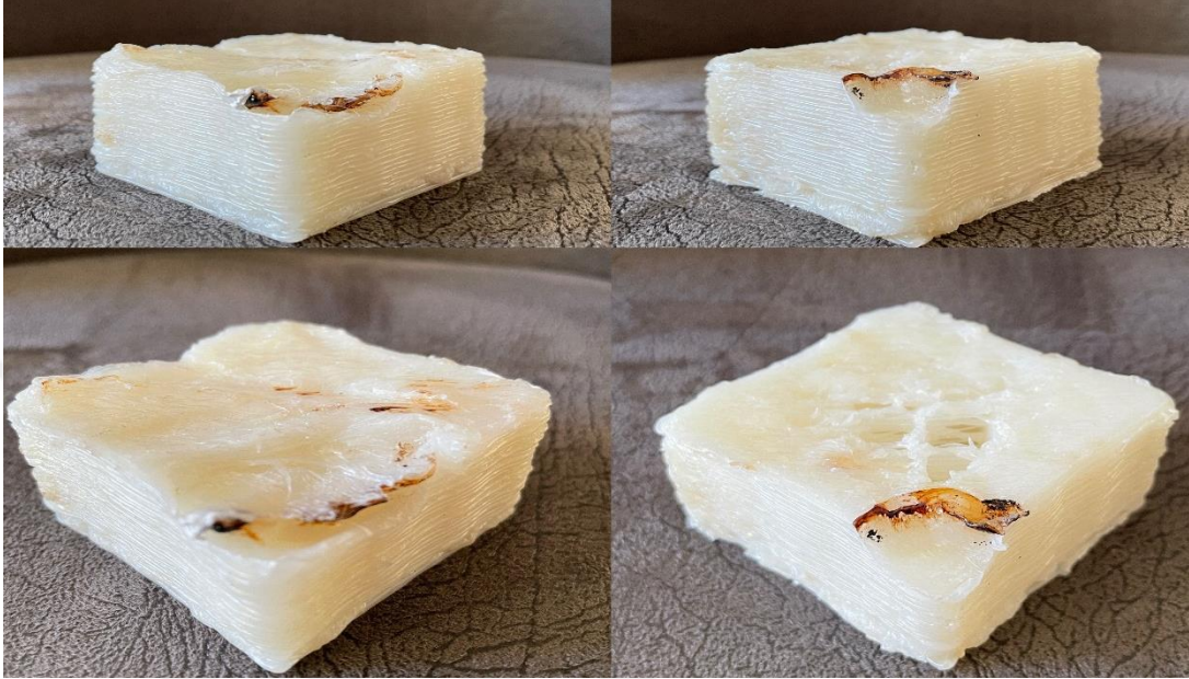
Görsel 4.3. Z ekseninde ekstruderin dalış yaparak bozduğu kalibrasyon parçaları
