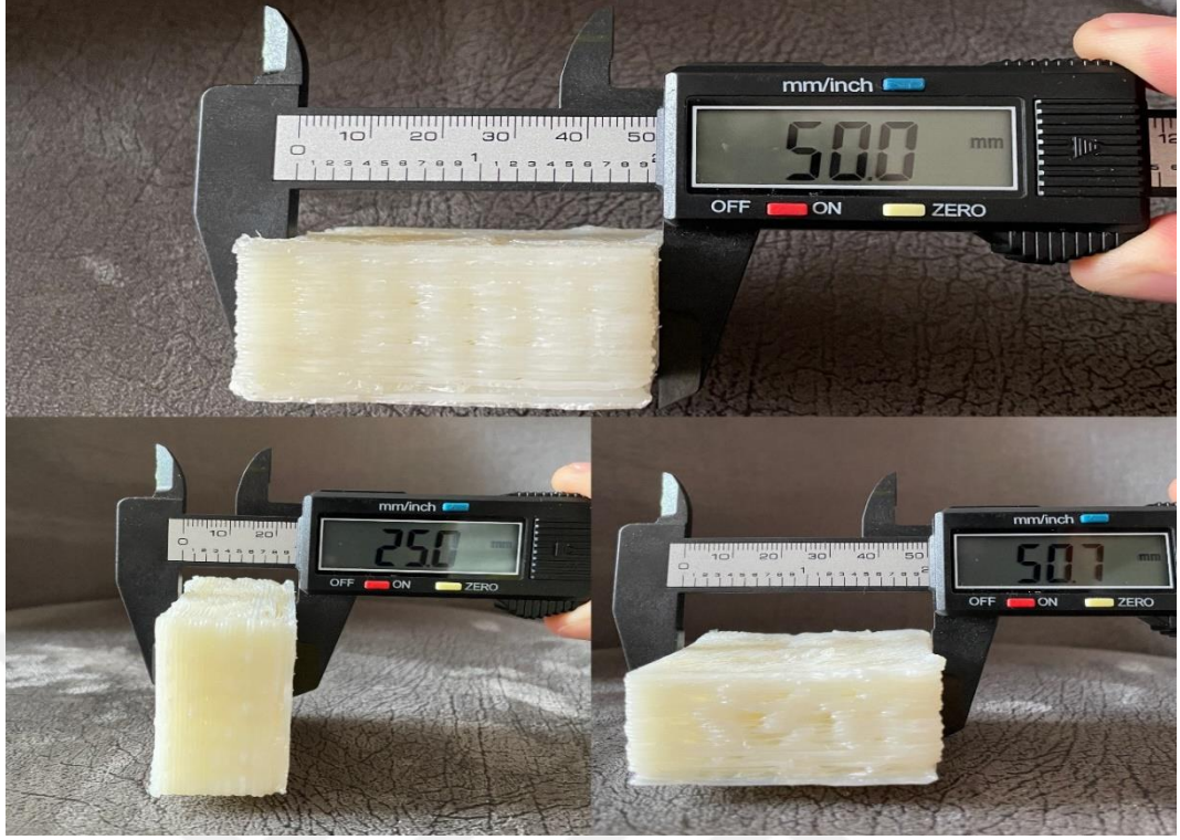
Görsel 4.6. Kalibre edilen 1 numaralı kalibrasyon parçası
