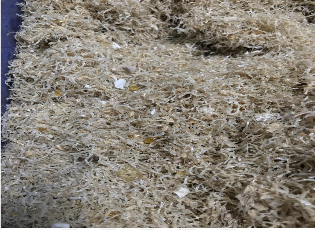
Görsel 3.27. Geri dönüşümü tamamlanmış Peek malzeme ve parçalara ayrılmış atık Peek talaşı
