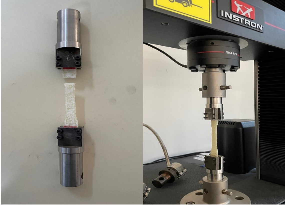
Görsel 3.39. Çekme testine maruz kalarak kopmuş numune ve çekme testi aşaması
