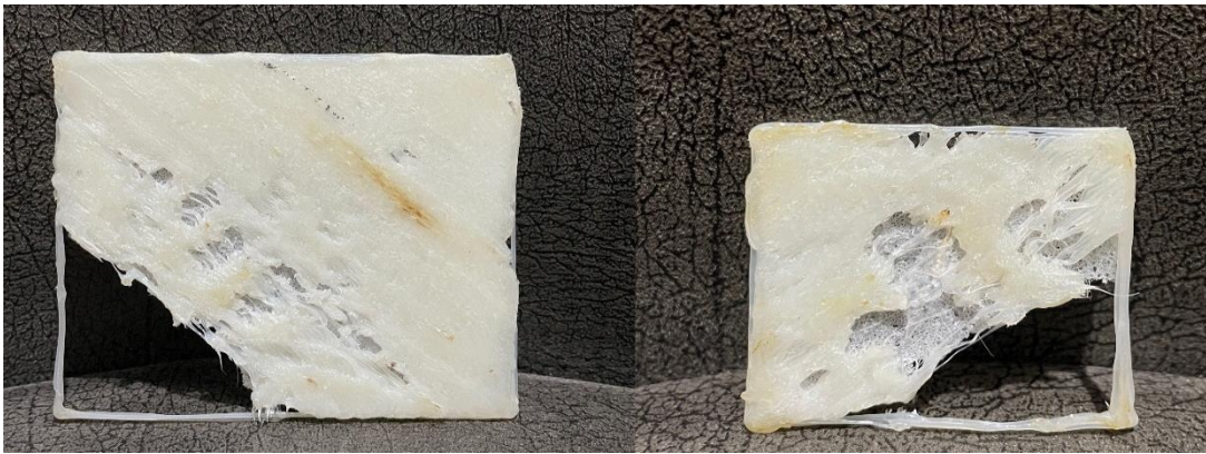
Görsel 4.2. Kalibrasyon parçası imalat hataları
