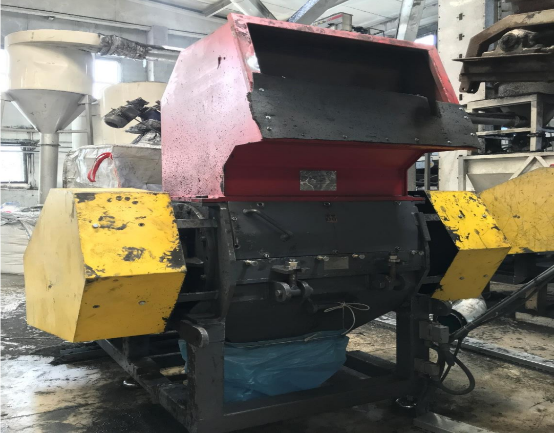
Görsel 3.26. Benli Geri Dönüşüm firmasına ait geri dönüşüm parçalama makinesi
