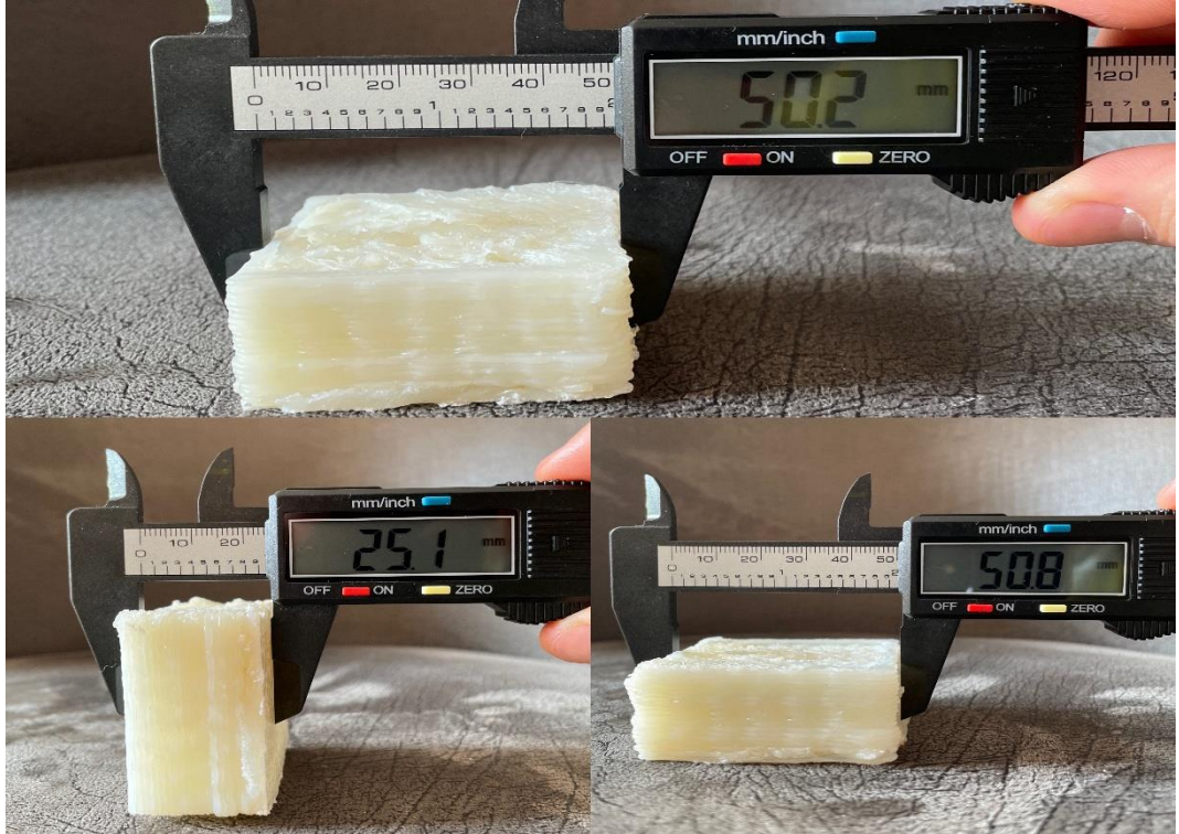
Görsel 4.7. Kalibre edilen 2 numaralı kalibrasyon parçası
