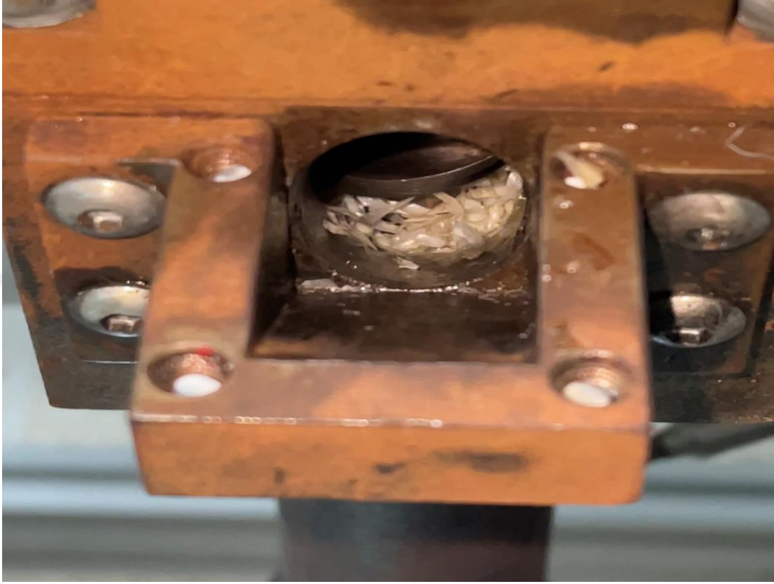
Görsel 3.28. Geridönüşüm PEEK malzemenin ekstruderdaki akış hatası
