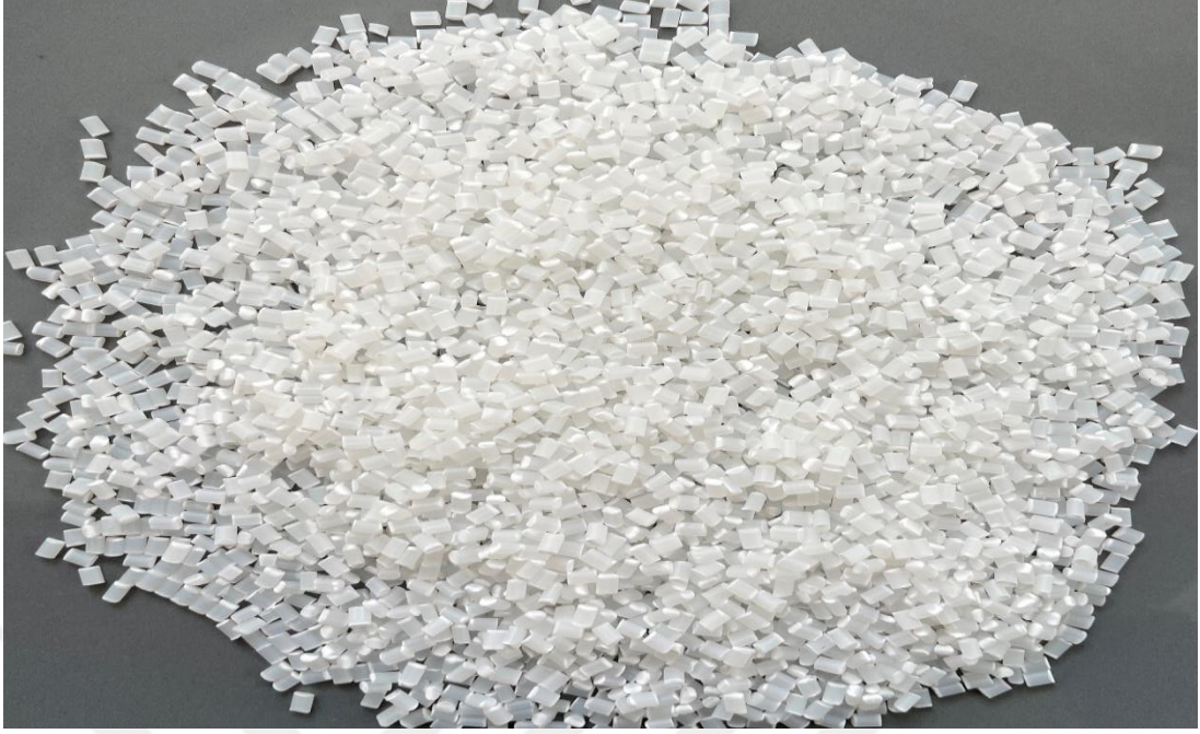
Görsel 3.33. OO-Kuma marka termoplastik performans ABS granülü
