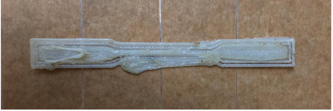
Görsel 3.16. ASTM D638 standartına uygun olmayan çekme test numunesi - 1
