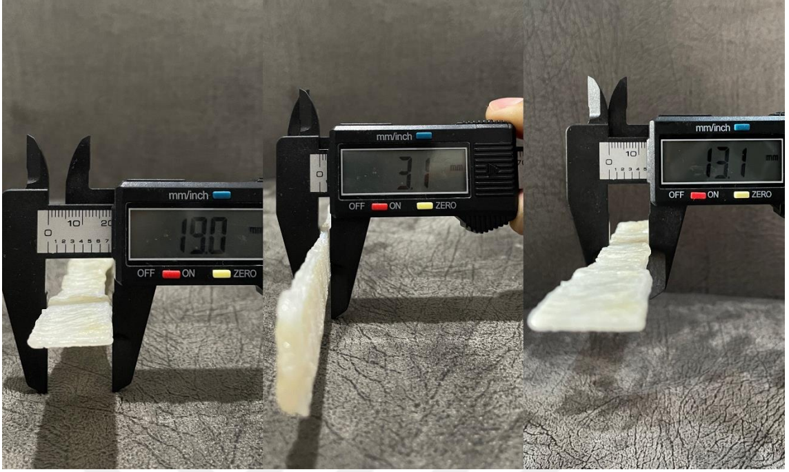
Görsel 3.37. L9 ortogonal dizisi dikkate alınarak imal edilen çekme test numunesi ölçümü
