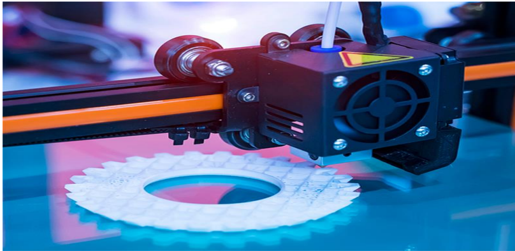
Görsel 1.11. FDM yöntemi ile parça imalatı (Texas Prototype, 2019)
