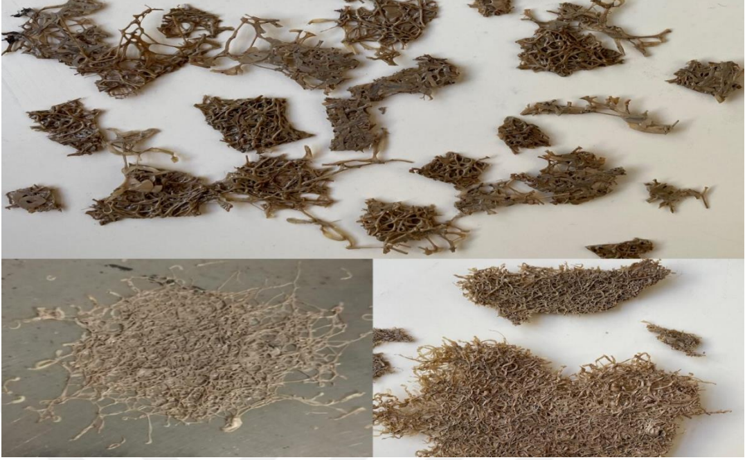
Görsel 3.31. Isıl işlem uygulanarak birleştirilmiş geri dönüşümlü Peek talaşı
