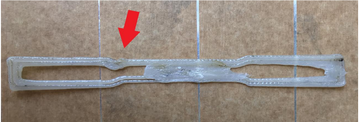
Görsel 3.18. ASTM D638 standartına uygun olmayan çekme test numunesi - 3
