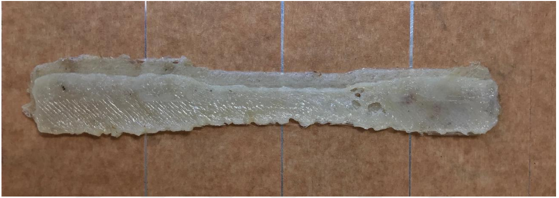
Görsel 3.17. ASTM D638 standartına uygun olmayan çekme test numunesi - 2
