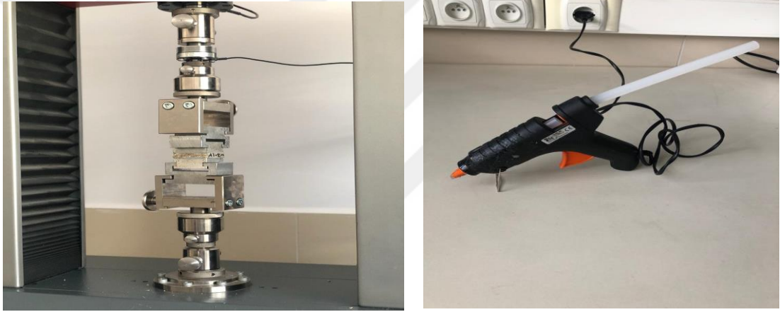
Şekil 15. YDÇD deney düzeneği ve mum silikon tabancası
