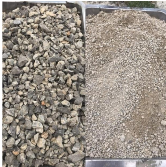
Şekil 3.1: Karışımında kullanılan iri agreg ve ince agreg.
