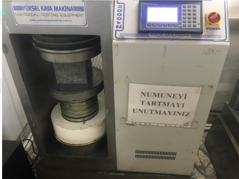
Şekil 3.11: Basınç dayanımı ölçme cihazı.
