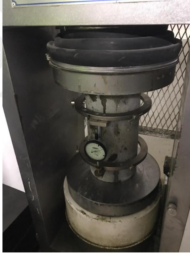
Şekil 3.15: 7 günlük elastisite modülü deneyi.
