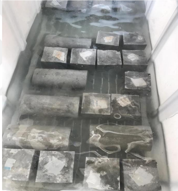
Şekil 3.10: Sertleşmiş birim ağırlıkları ölçülmüş numuneler.
