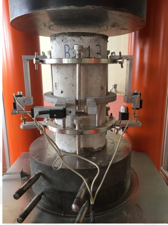
Şekil 3.16: 28 ve 90 günlük elastisite modülü deneyi.
