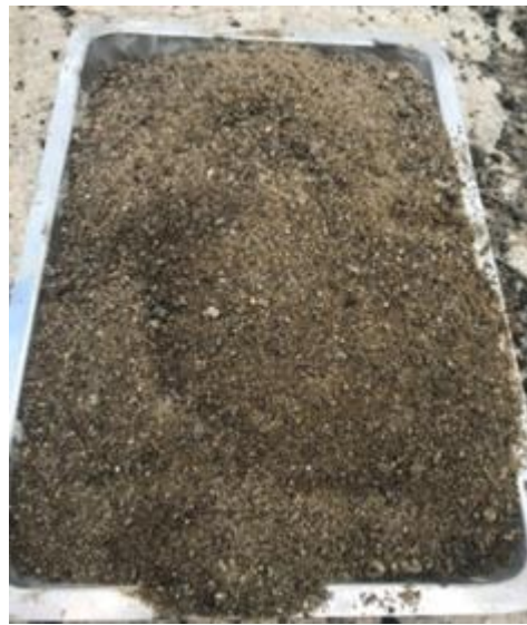
Şekil 3.2: Karışım da kullanılan granüle yüksek fırın cürufu.
