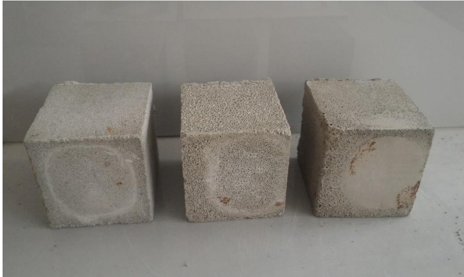
Şekil 13: Prizini tamamlamış köpük beton.
