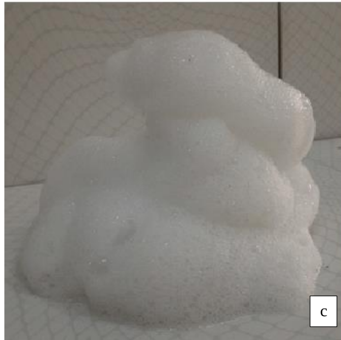
Şekil 8: Köpük üretimi, (a) köpük ajanının suya ilave edilmesi, (b) köpük ajanı ile suyun karıştırılması, (c) elde edilmiş köpük.
