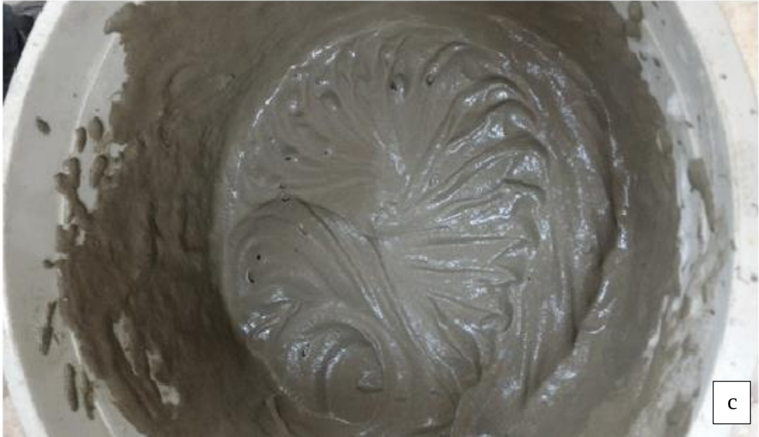
Şekil 11: Köpük beton, (a) harcın köpüğe ilave edilmesi, (b) köpük ile harcın karıştırılması, (c) elde edilmiş köpük beton.
