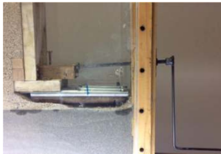
Şekil 2.11. Zemin itkisi ile duvar ötelenmesinde kullanılan mekanizma.
