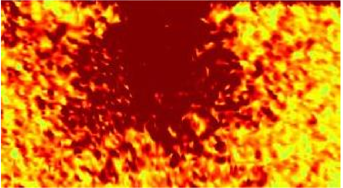
Şekil 4.56. Tane çapı 3,35-4,75 mm aralığında olan köşeli zeminin %70 rölatif sıklıkta yer değişimi
