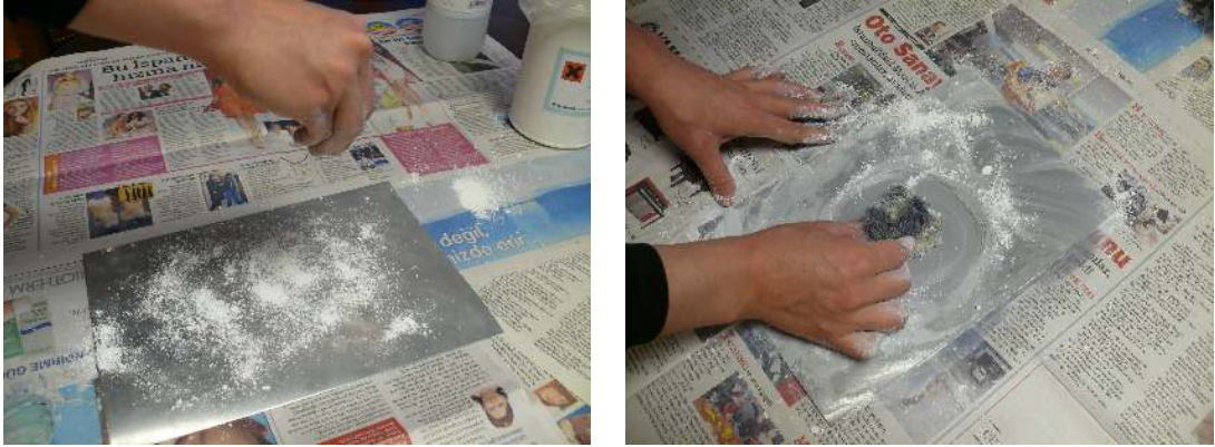
Resim 88-89. Plakanın üstübeç ve alkol ile temizlenmesi
