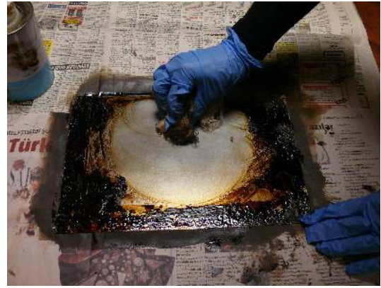
Resim 95-96. Asitten çıkarılan plakanın su ile yıkanması ve kurutulduktan sonra gazla silinerek temizlenmesi
