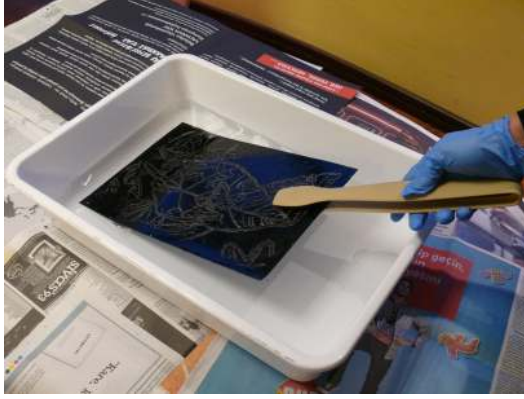
Resim 93-94. Plakanın asit küvetine atılması ve oluşan hava kabarcıklarının alınması
