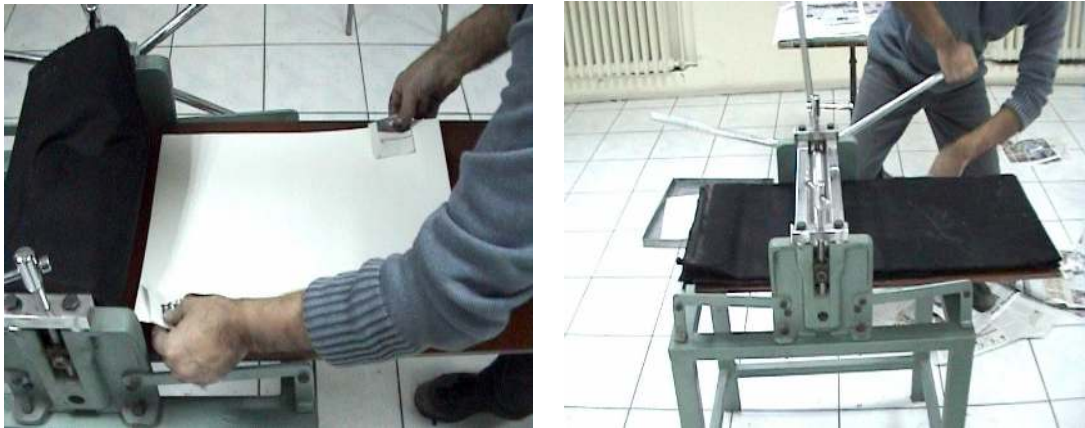
Resim 103-104. Plakanın pres tablasına yerleştirilerek üzerine kağıt konması ve presten kalıbın geçirilmesi
