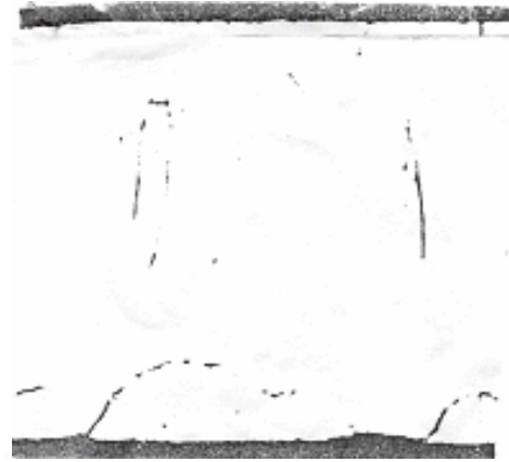
Şekil 2.26 Ötektik bileşimindeki Ag - 28Cu ergitme tel alaşımında tek katı çözelti fazının sütunlu taneleri. Tam bant eksen kesiti. Kasnak tarafı (soğuk taraf) alt taraftır. Dağlama çözeltisi: Taze hazırlanmış 20 ml NH 4 OH, 10 ml % 3’lük H 2 O 2 , 10 ml H 2 O. 2000 x Büyütme (Boettinger ve diğ., 1982).
