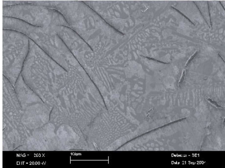
Şekil 5.63. Dubleks döküm tekniğiyle üretilen 7 nolu numunenin dendiritik yapının da bulunduğu gri dökme demirli bölgesinin SEM fotoğrafı.
