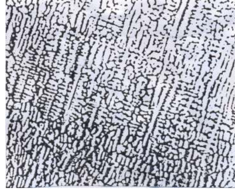
Şekil 2.14. Ni-25Cu (% atom) alaışımı, kesit dendritik katılaşma yapısını göstermektedir. 70 ml \text{HNO}_3 ve 30 ml \text{H}_2\text{O} karışımında dağlanmış, 10 x Büyütme(ASM Handbook , 1988).
