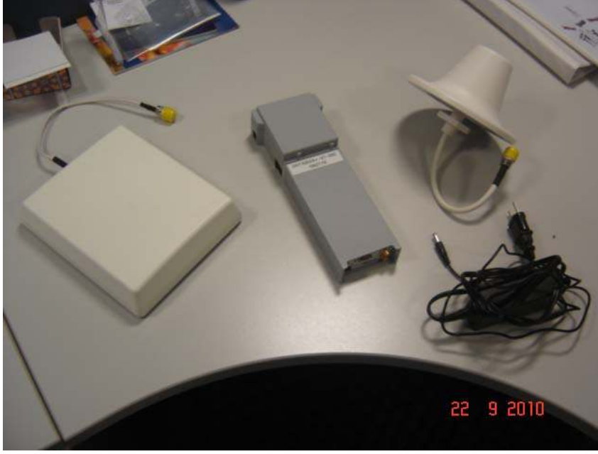
Şekil 3.2. Test sinyal üretici cihazı yönlü ve yönsüz dahili antenler
