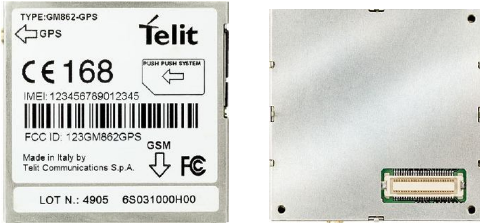
Şekil 4.2. GM862 modülün üstten ve alttan görünümü.
