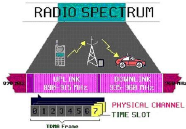
Şekil 3.8. GSM 900Mhz frekans kanalları.
