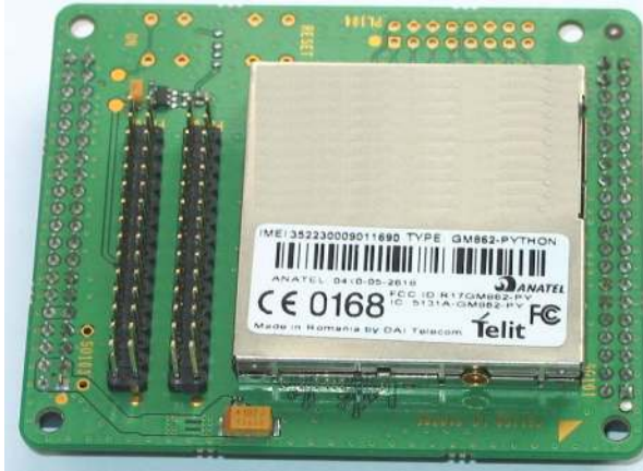
Şekil 4.3. GM862 modülü ve arayüz kartı.
