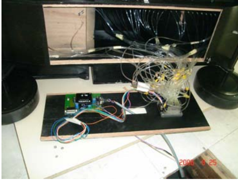
Resim 5.17. Basınç hortumlarının çoklu basınç ölçere bağlantısı
