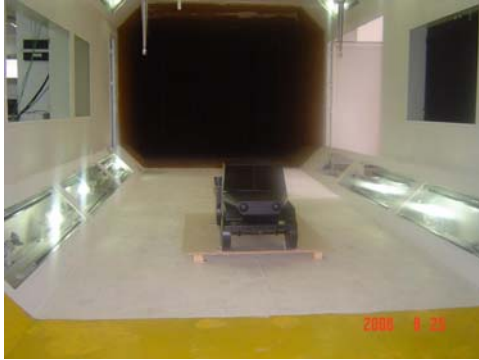
Resim 5.18. Test odasında deneye tabi tutulacak taşıtın konumu
