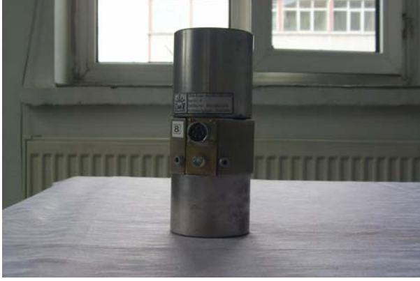
Resim 5.22. Kuvvet ölçümünde kullanılan dinamometre
