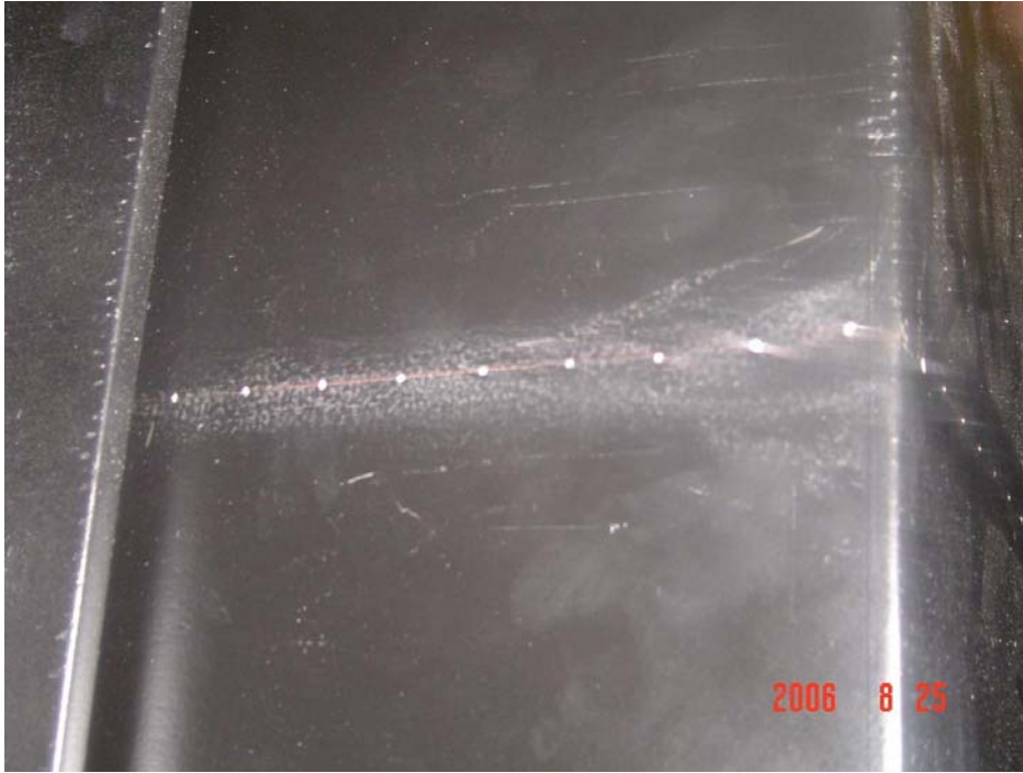
Resim 5.15. Basınç delikleri (1mm çapında)
