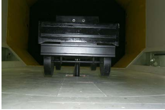
Resim 5.25. Direnç ölçme deneyine tabi tutulacak model aracın konumu (arka)
