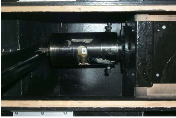
Resim 5.24. Dinamometrenin model araçla bütünlenmesi
