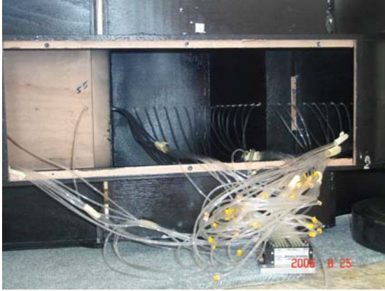
Resim 5.16. Basınç hortumlarının montajı
