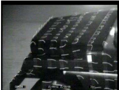
Resim 6.3. Hız 15 m/s için taşıtın ön kaput kısmı
