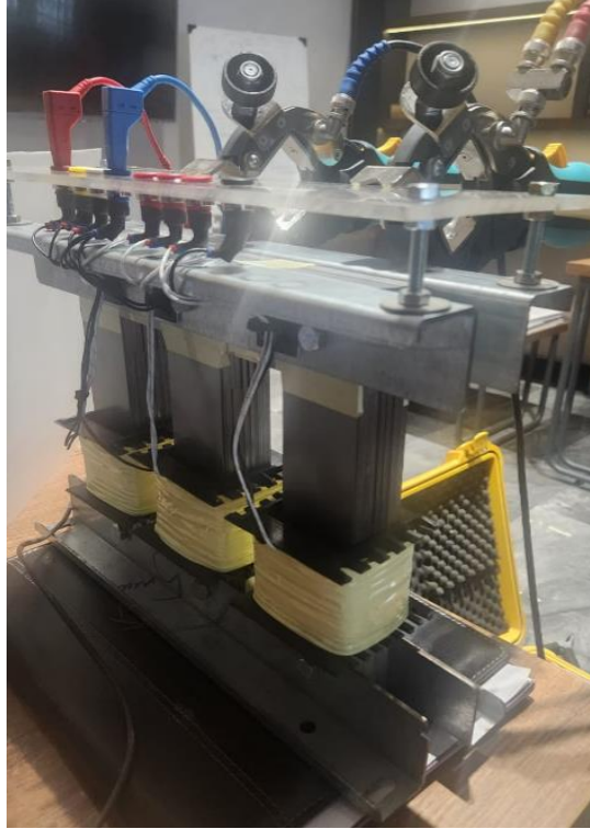
Şekil 4.3. SFRA Verilerinin Toplanması İçin Hazırlanan Test Düzeneği
