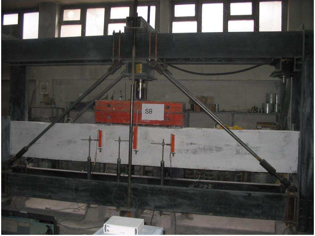
Resim 4.2. SB deney elemanı
