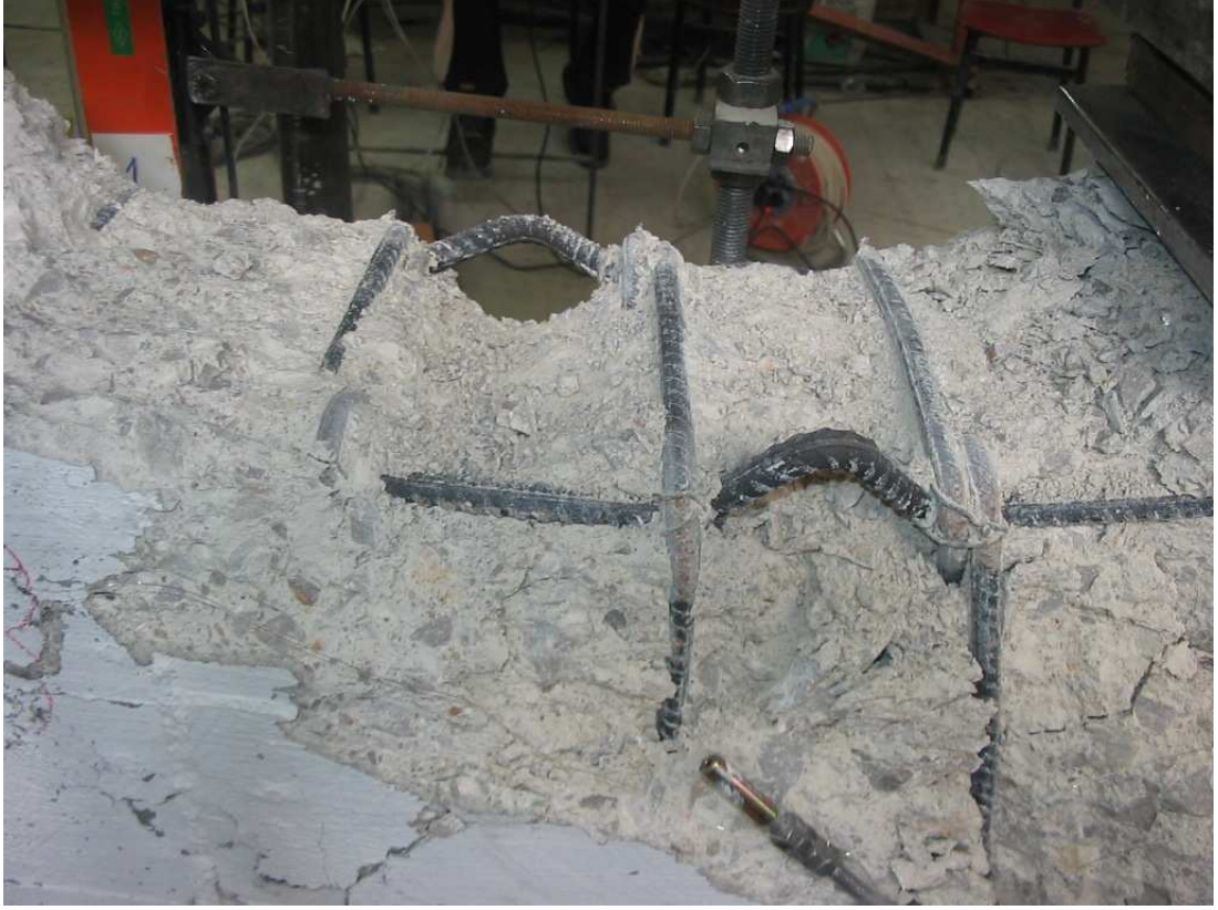
Resim 4.5. Sbb3 deney elemanı basınç donatılarında burkulma
