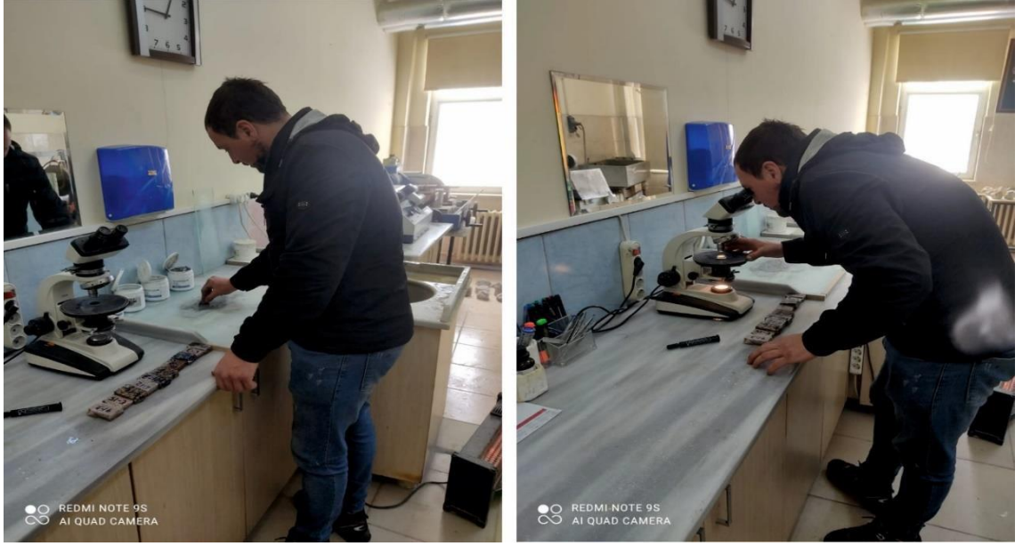
Şekil 5. Aşındırıcı tozlar ile kesitlerin hazırlanması ve kesit kalınlığının kontrolü
