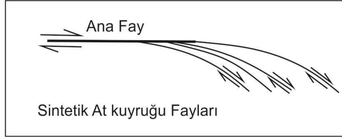
Şekil 1.5 Doğrultu atımlı fayların sonlanma modellerinden sintetik at kuyruğu (yay) fayları (Grohmann ve Hargitai, 2014)
