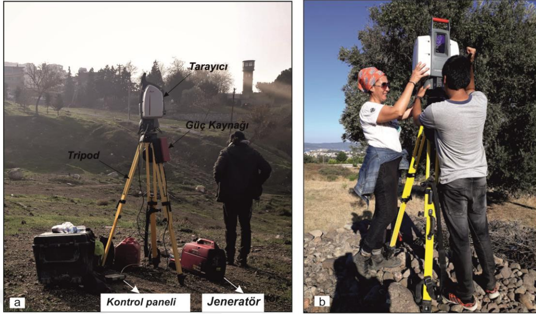
Şekil 1.27 a) TLS sistemini oluşturan tarayıcı, tripod, güç kaynağı ve kontrol panelinden bir görüntü b) TLS sisteminin kurulması (Kişisel arşiv, 2019)
