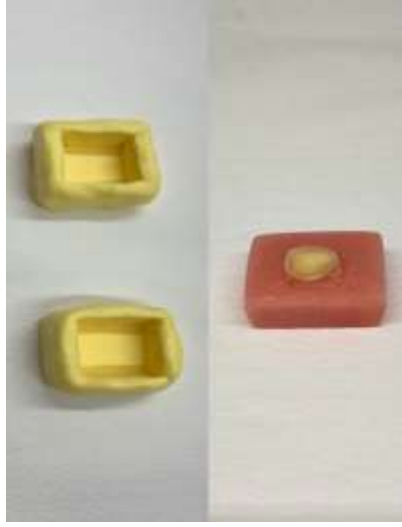
Şekil 3.10: Dişlerin Gömülmesi için Hazırlanan Silikon Kalıp ve Soğuk Akriliğe Gömülmüş Diş Örneği.
