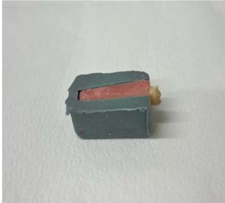
Şekil 3.8: Dişlerin Gömülmesi için Hazırlanan Silikon Kalıp ve Oklüzal Yüzeyi Dışarıda Kalacak Şekilde Akriliğe Gömülmüş Diş Örneği.
