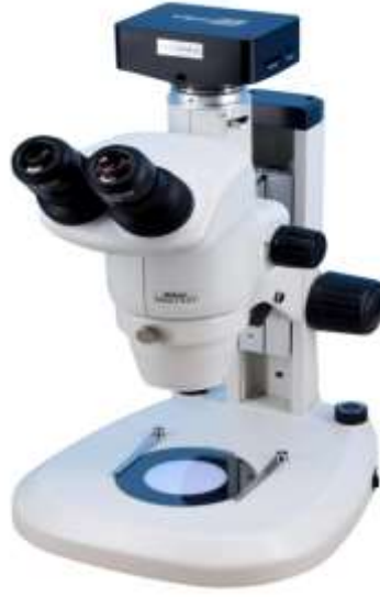
Şekil 3.4: Çalışmada Kullanılan Stereo Mikroskop Cihazı (Nikon SMZ745T, Nikon, ABD).
