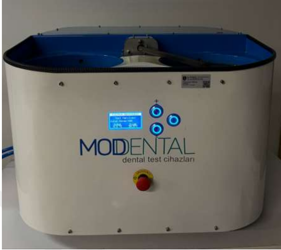
Şekil 3.6: Çalışmada Kullanılan Termal Siklus Cihazı (MOD Dental, Esetron Smart Robotechnologies, Ankara, Türkiye).
