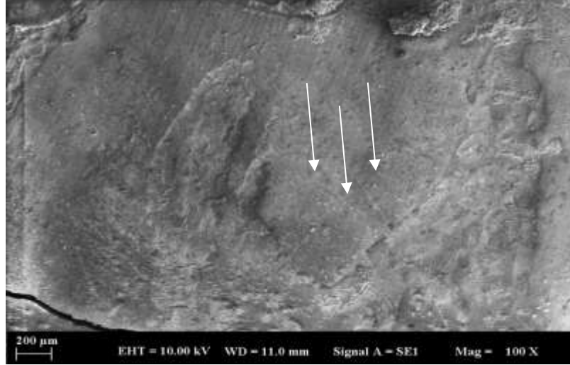
Şekil 4.11: Grup 3'e ait Adeziv Kırık Gözlemlenen Bir Örneğin Taramalı Elektron Mikroskobu Görüntüsü (X100 büyütme). (Restorasyonun Dış Yüzeyinden Tamamen Ayrıldığı Bölge Beyaz Ok ile Gösterilmiştir).
