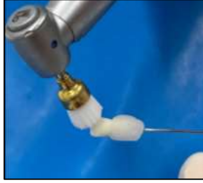
Şekil 3.1: Örneklerin Mikromotor ve Fırça Yardımı ile Temizlenmesi.
