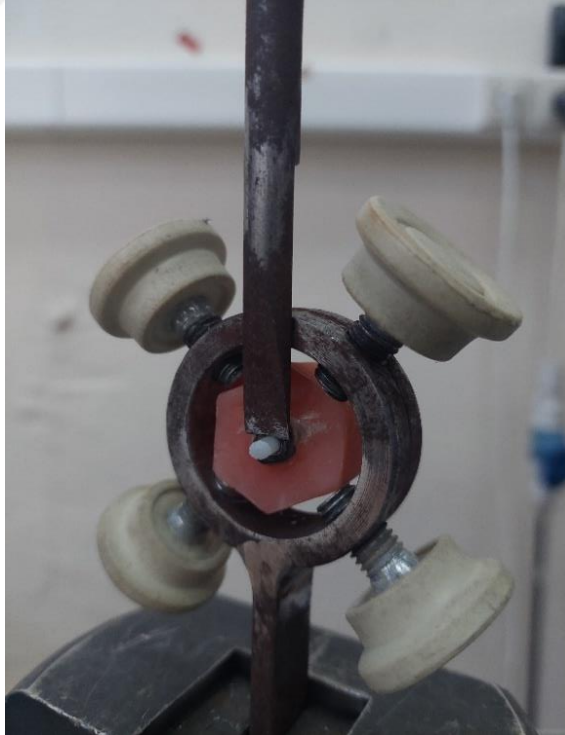
Resim 13. Örneklerin Instron Universal Test Cihazına Yerleştirilmesi
