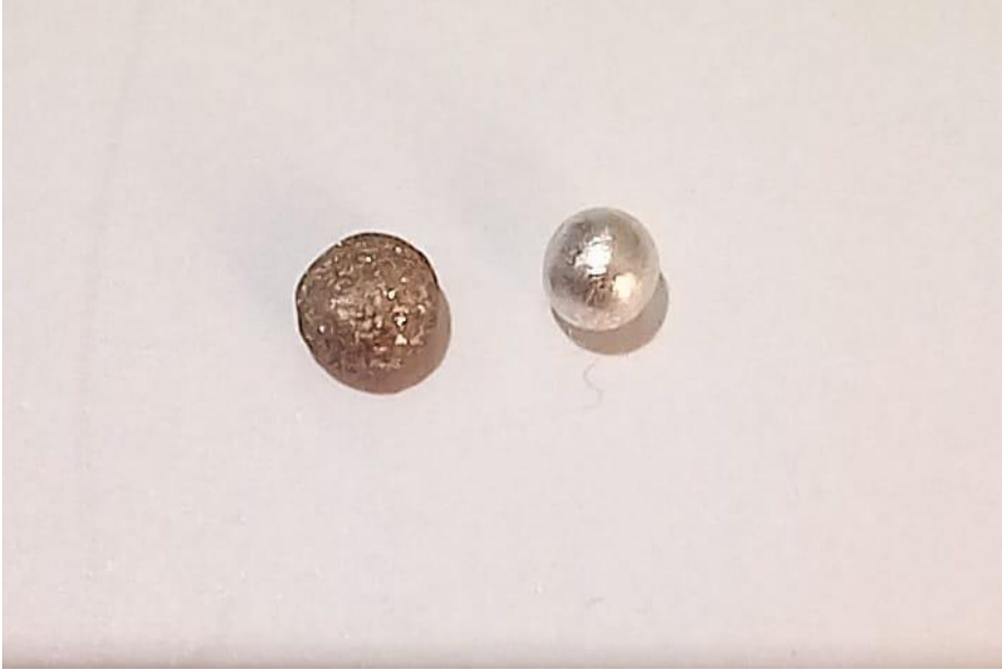
Şekil 5.8. 3.0 M H_2O_2 konsantrasyonunda yapılan deney sonucu elde edilen oksidasyona uğramış gümüş.
