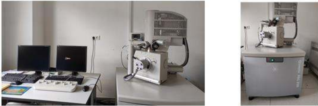
Şekil 3.3: Qanta Feg 250 Taramalı elektron mikroskobu (SEM) ve bağlantılı EDX'in iki fotoğrafı.
