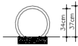
Şekil 3.13. Şehirlerarası Otobüs Terminali Bisiklet Park Yeri Detayları
