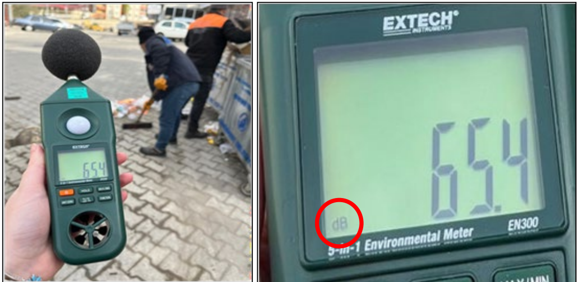
Şekil 22. Atık toplama gürültü ölçümü
