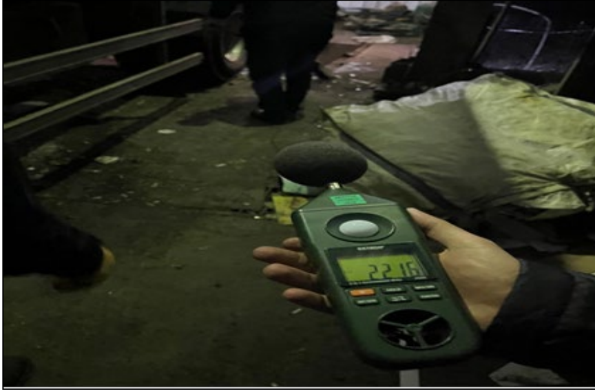
Şekil 27. Atık ayrıştırma aydınlatma ölçümleri
