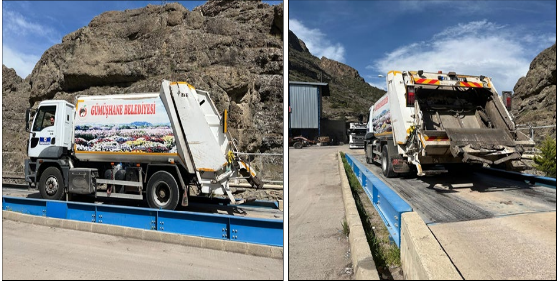
Şekil 13. Atık taşıma aracı ağırlık ölçümü
