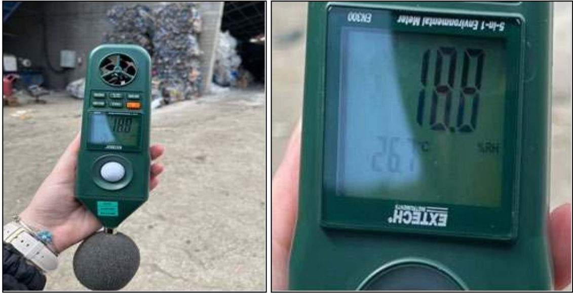
Şekil 30. Atık ayrıştırma hava kalitesi ve sıcaklık ölçümleri
