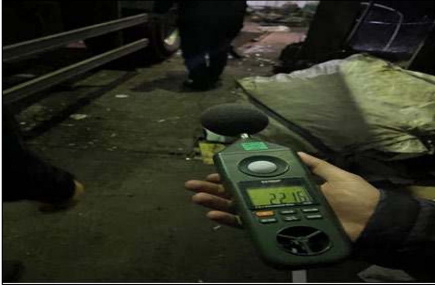
Şekil 27. Atık ayrıştırma aydınlatma ölçümleri
