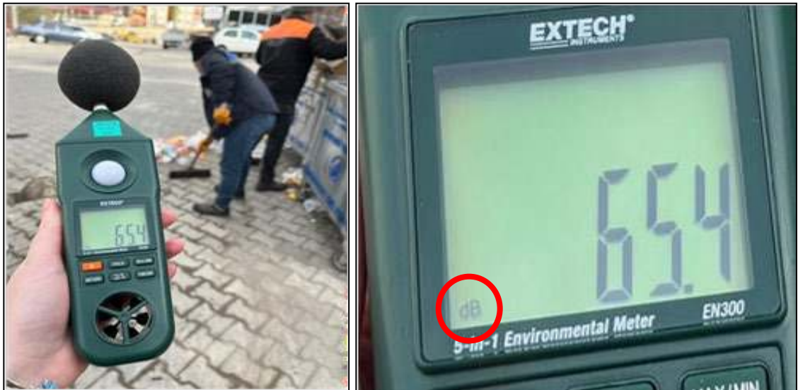
Şekil 22. Atık toplama gürültü ölçümü
