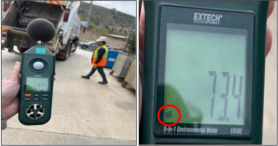
Şekil 23. Atık taşıma gürültü ölçümü
