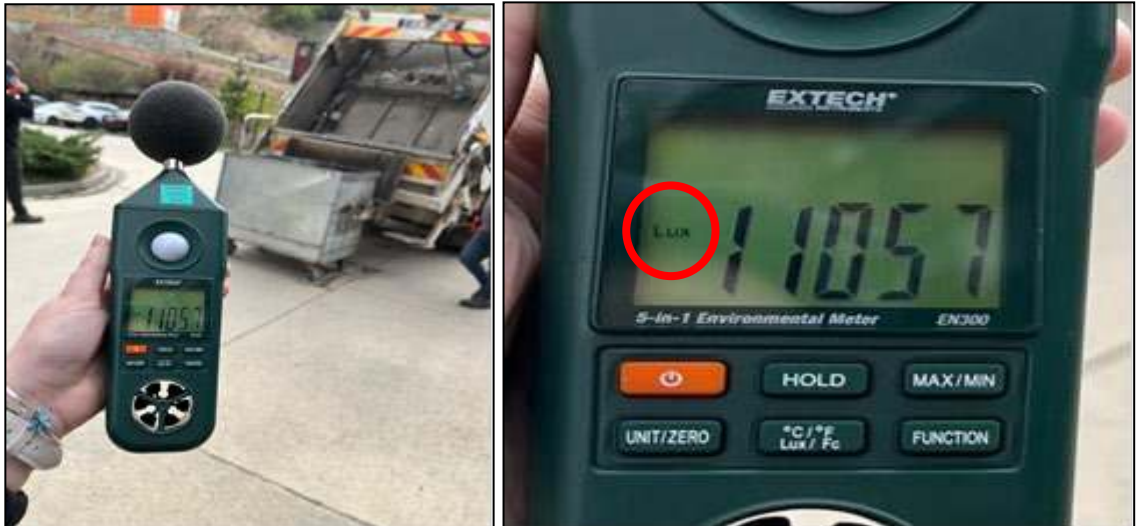
Şekil 26. Atık taşıma aydınlatma ölçümleri
