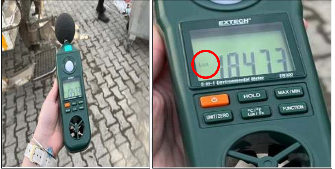
Şekil 25. Atık toplama aydınlatma ölçümleri
