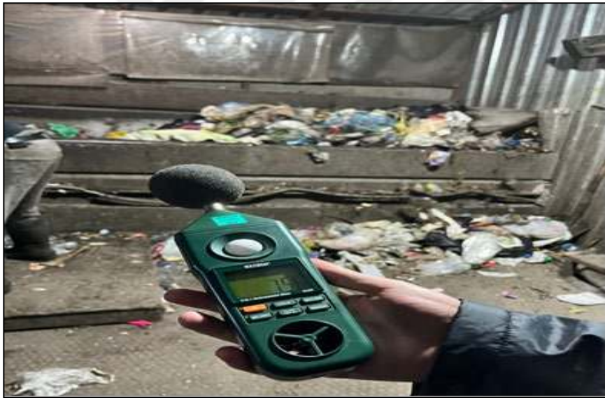
Şekil 24. Atık ayrıştırma gürültü ölçümü
