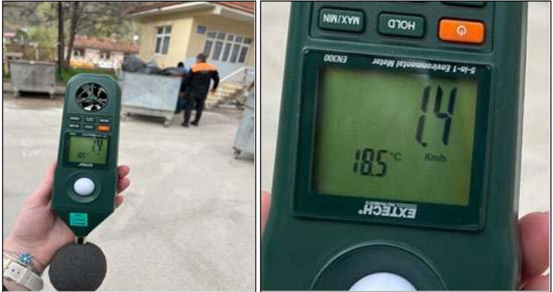
Şekil 28. Atık toplama hava kalitesi ve sıcaklık ölçümleri
