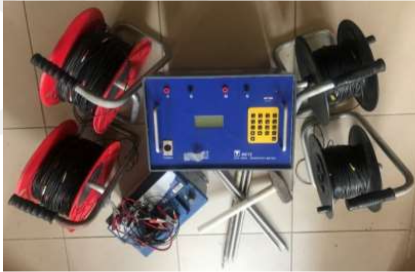
Şekil 37. DES ölçümlerinde kullanılan arazi ekipmanları
